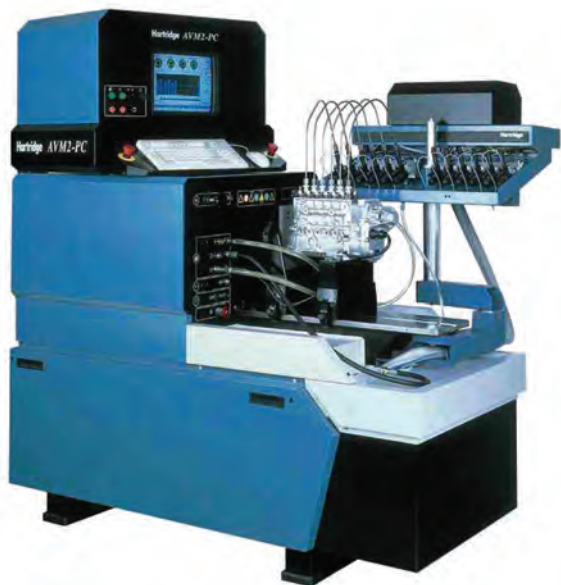
شکل ۲۴-۴- دستگاه آزمودن و تنظیم پمپ انژکتور
