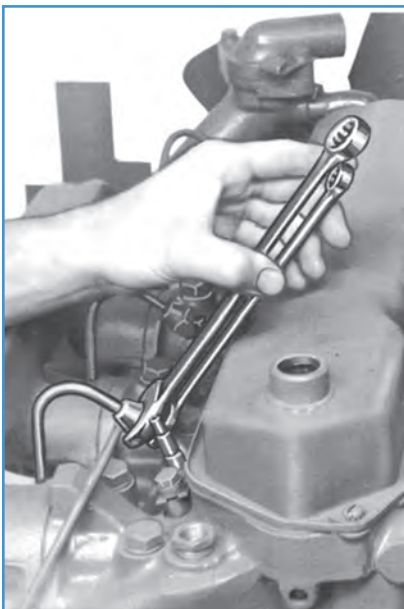
شکل ۲۲-۴- باز کردن لوله‌های فشارقوی انژکتورها
