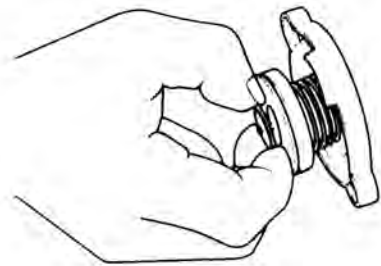
شکل ۱۷-۳- آزمون سوپاپ مکش در رادیاتور
