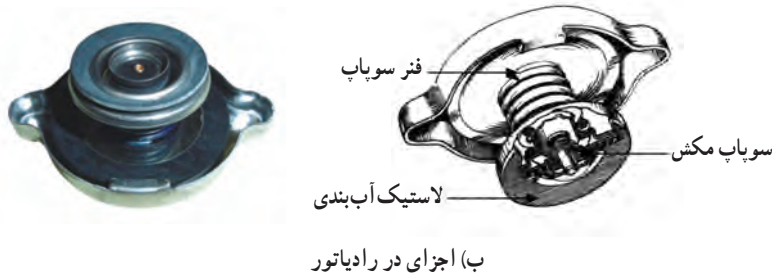
شکل ۳-۵- در رادیاتور و طرز کار سوایپ‌های آن
