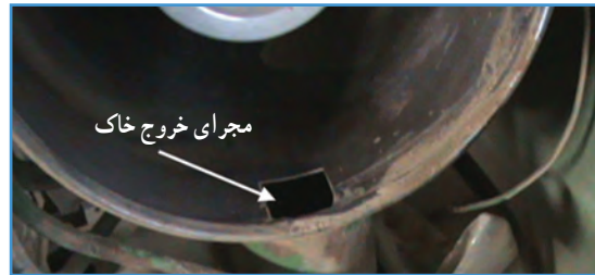
شکل ۱۱-۵ محل خاکدان در تراکتور جان‌دیر
