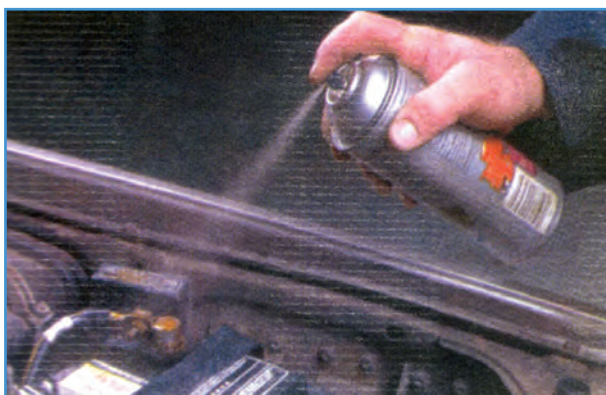
شکل ۱۱-۶- پاشیدن اسپری ضد خوردگی روی بست باتری
