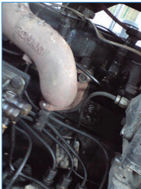
شکل ۳۱-۵- محل اتصال مانیفولد به سرسیلندر تراکتور U650
