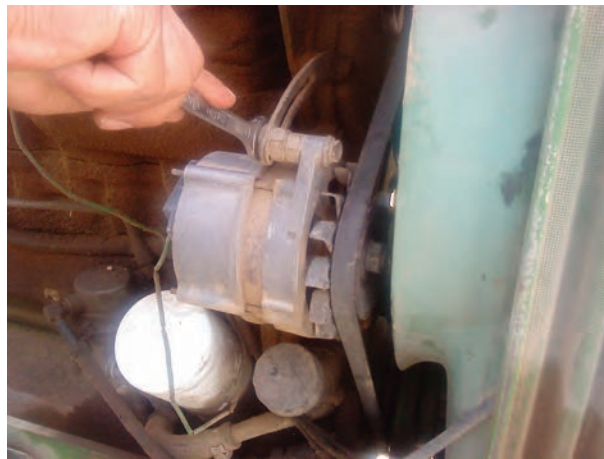
شکل ۳۸-۶ سفت کردن پیچ تنظیم آلترناتور
