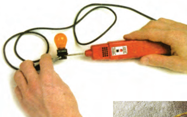
الف) لامپ آزمایش باتری دار
