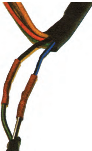
شکل ۶۷-۶- اتصال کامل سیم‌ها با روکش تیوب عایق
