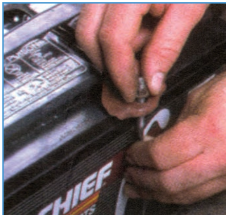
شکل ۹-۶- باز کردن بست نگهدارنده باتری
