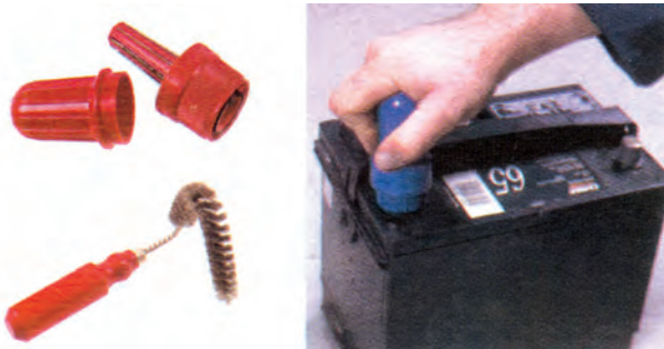
شکل ۲۳-۶- تمیز کردن قطب‌های باتری با ابزار مخصوص
