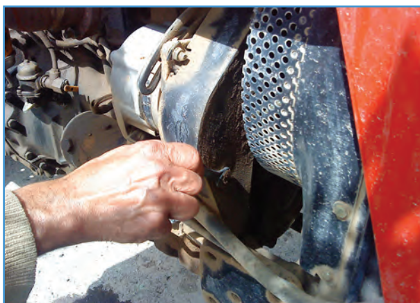
شکل ۳۲-۶ باز کردن روکش محافظ تسمه
