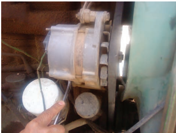
شکل ۳۹-۶ سفت کردن پیچ پایه
