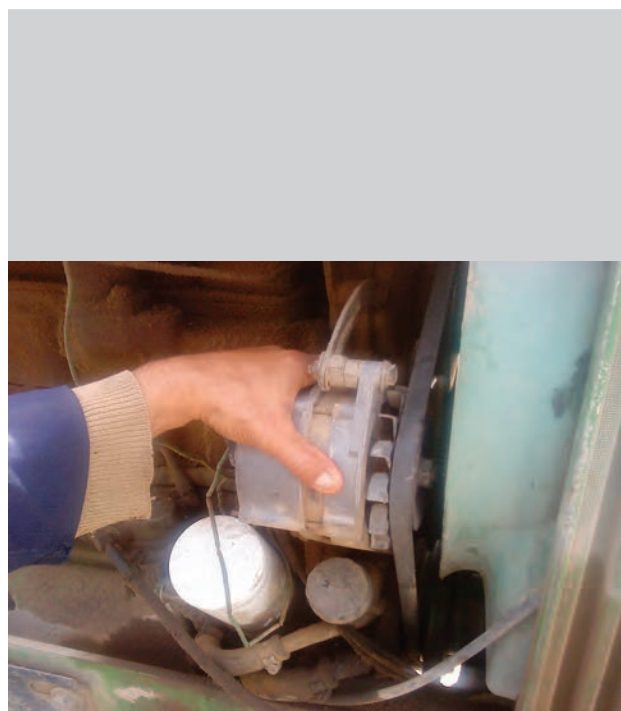
شکل ۳۷-۶- عقب کشیدن آلترناتور
