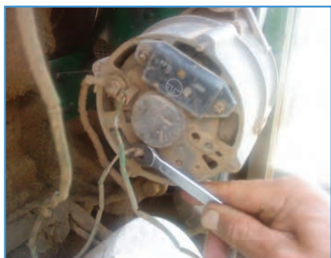
شکل ۳۵-۶- بستن سیم نازک
