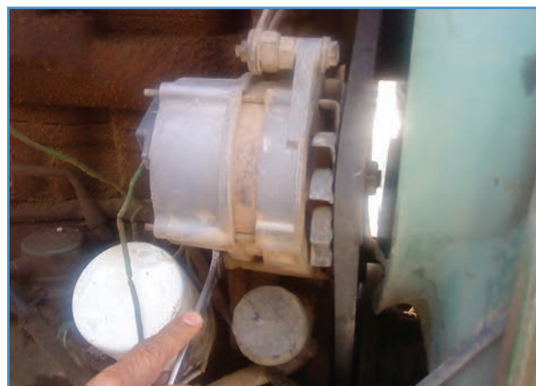
شکل ۳۱-۶ باز کردن پایه آلترناتور
