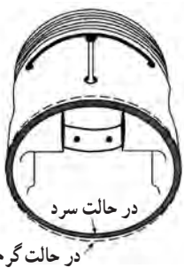
شکل ۱۹-۲- وضعیت پیستون در حالت گرم و سرد
