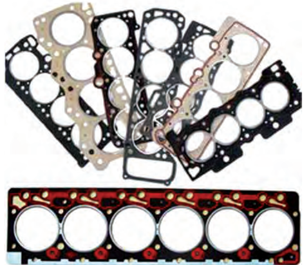
شکل ۶-۲ - چند نوع واشر سرسیلندر
