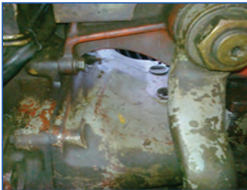
شکل ۹-۳- پیچ‌های اتصال موتور به جعبه‌دنده قسمت بالا
