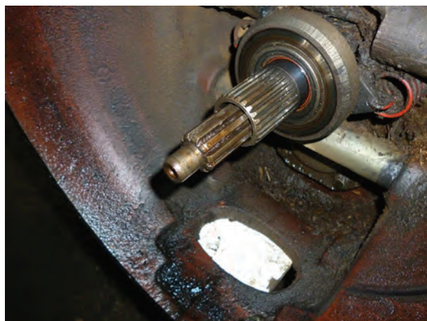
شکل ۱۳-۳- شافت ورودی جعبه‌دنده
