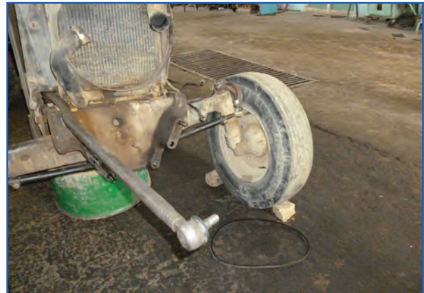
شکل ۱۹-۳- قسمت جلوی تراکتور جدا شده از موتور
