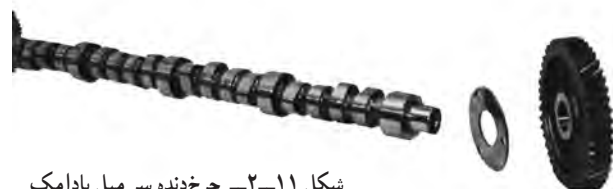
شکل ۱۱-۲ - چرخ‌دنده سر میل بادامک
