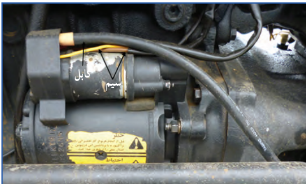
ب) سیم و کابل متصل به استارت‌تر
