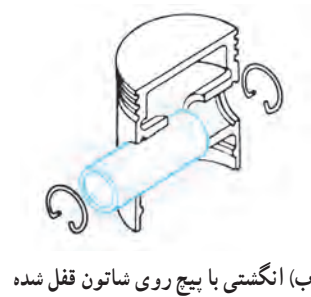
شکل ۳۱-۲- انواع اتصال انگشتی به پیستون
