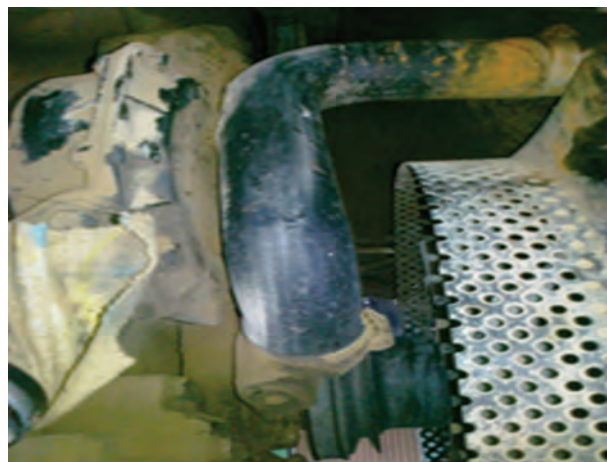
شکل ۱۵-۳- اتصال شیلنگ رادیاتور
