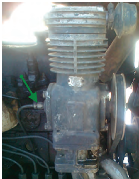
شکل ۵-۸- لوله روغن کاری کمپرسور در تراکتور U650
