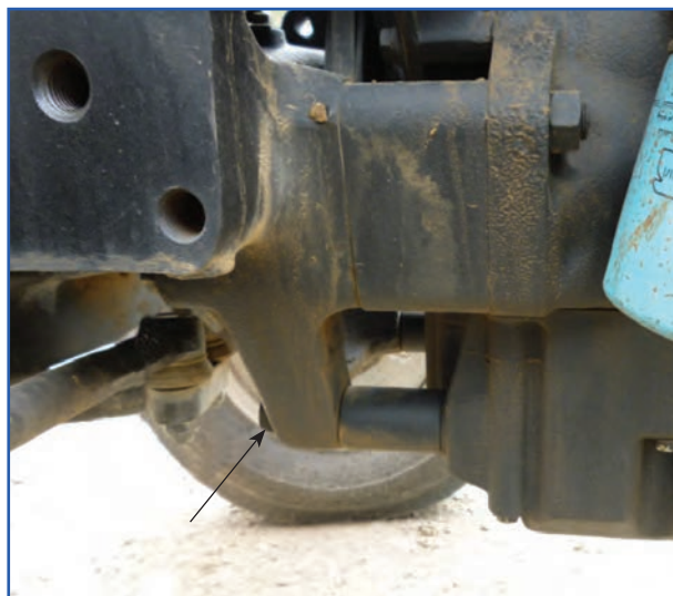
شکل ۱۷-۳- محل پیچ‌های اتصال موتور به جلوی تراکتور
