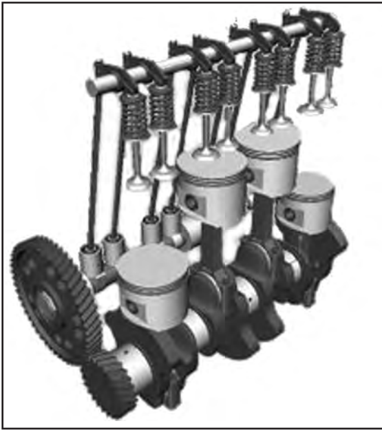
شکل ۸-۲ - قطعات مکانیزم باز و بسته شدن سوپاپ‌ها
