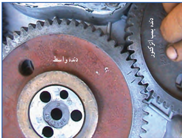
شکل ۱۵-۲- نشانه روی چرخ دنده های واسطه میل لنگ و سر پمپ انژکتور تراکتور MF285
