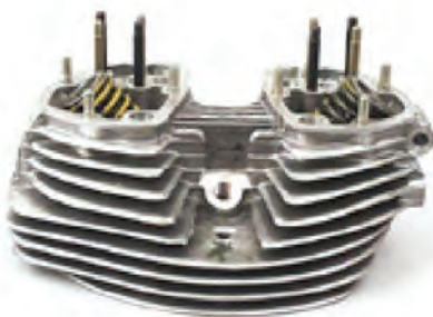
شکل ۳-۲ - سر سیلندر موتور هوا خنک
