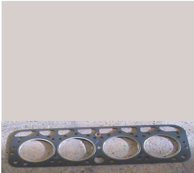
شکل ۷-۲ - ورق فولادی اطراف لبه واشر سرسیلندر
