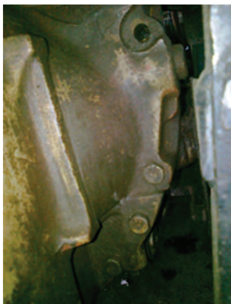
شکل ۱۱-۳- پیچ‌های اتصال موتور به جعبه‌دنده قسمت پایین
