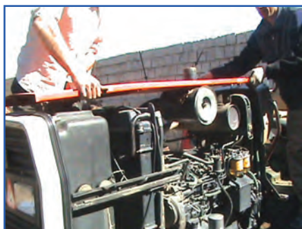
ج) برداشتن پوشش بالای موتور
