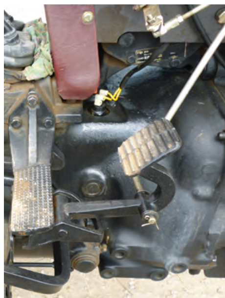
شکل ۱۱-۳- پیچ‌های اتصال موتور به جعبه‌دنده قسمت پایین
