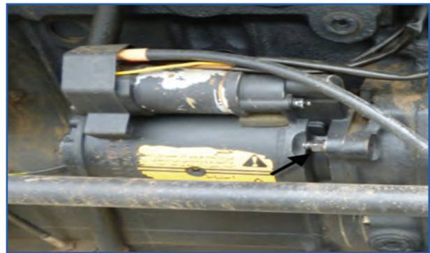
شکل ۳-۸- پیچ‌های نگه‌دارنده استارت‌تر تراکتور MF285
