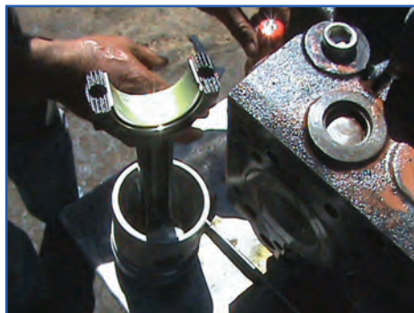
شکل ۱۹۲-۴- روغن‌کاری رینگ‌ها، پیستون و یاتاقان
