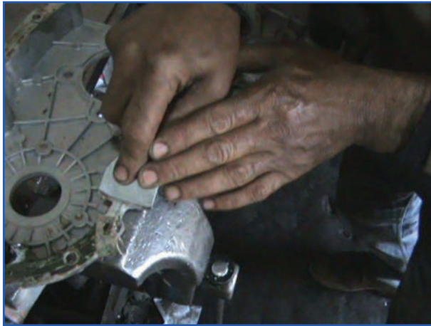
شکل ۷۶-۴- تمیز کردن واشر محفظه جلو موتور
