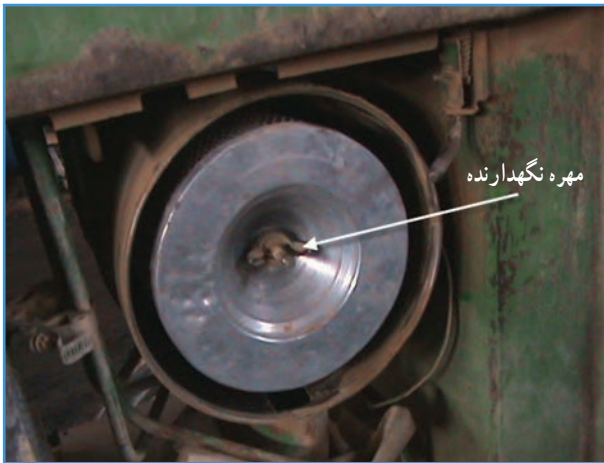
شکل ۱۰-۵ باز کردن شبکه بغل
