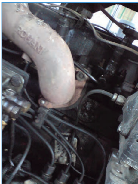
شکل ۳۱-۵- محل اتصال مانیفولد به سرسیلندر تراکتور U650
