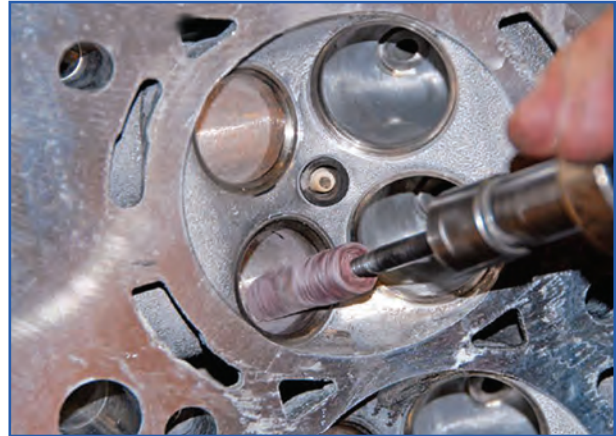
الف) نحوه تمیز کردن محفظه پشت سوپاپ
