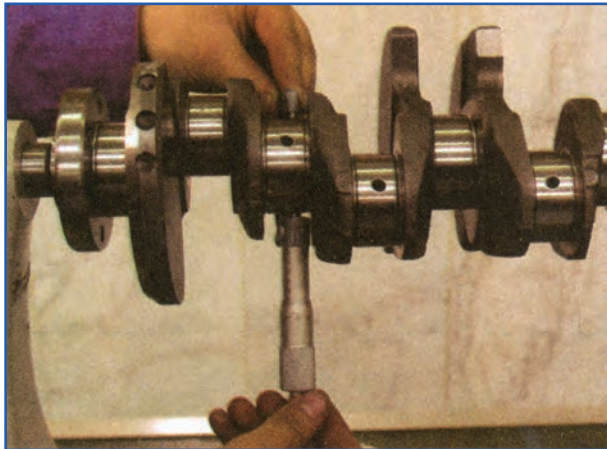
شکل ۱۶۲-۴- اندازه‌گیری قطر محورهای میل‌لنگ
