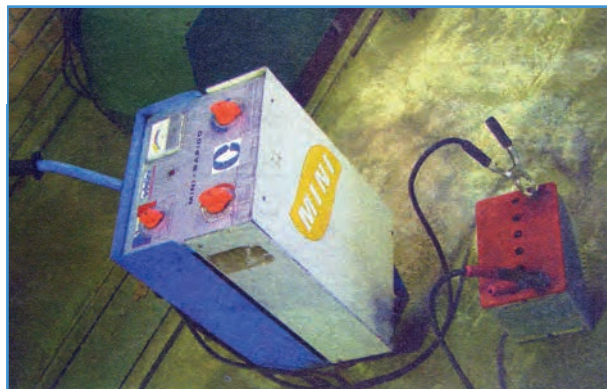
شکل ۱۸-۶ اتصال کابل‌های شارژر به باتری
