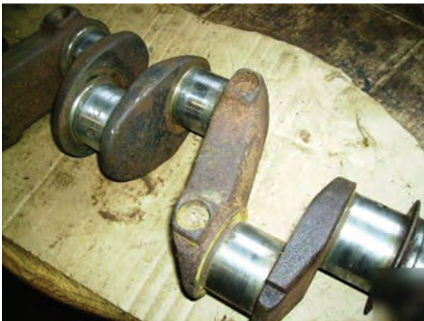
شکل ۲۱۰-۴- میل‌لنگ با رسوبات کربن
