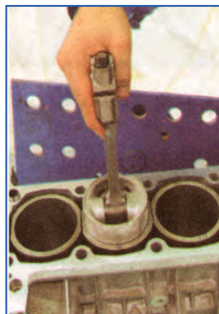
شکل ۱۲۷-۴- طرز قرار دادن رینگ داخل سیلندر
