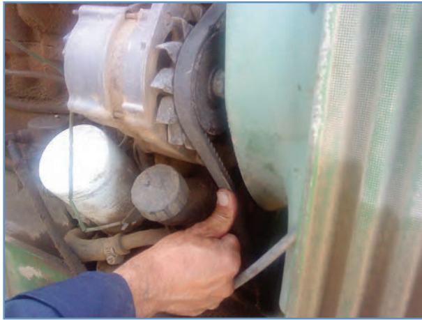
شکل ۲۸-۳- اندازه‌گیری کشش تسمه با فشار انگشت
