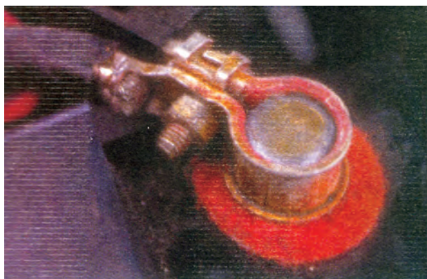
شکل ۱۰-۶- مالیدن گریس به بست باتری
