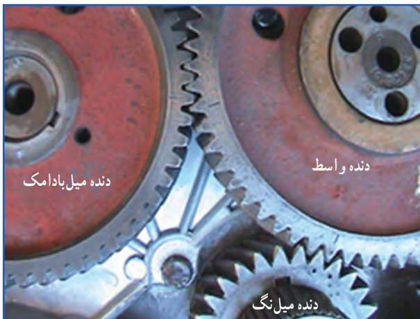
ب) علامت روی چرخ دنده تایمینگ تراکتور MF285
