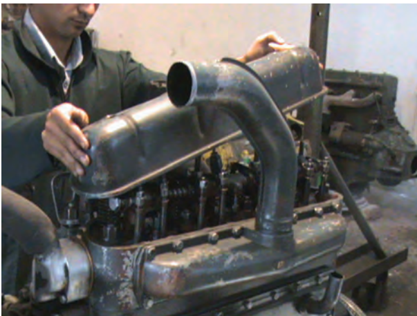
شکل ۴-۷- برداشتن درپوش سوپاپ
