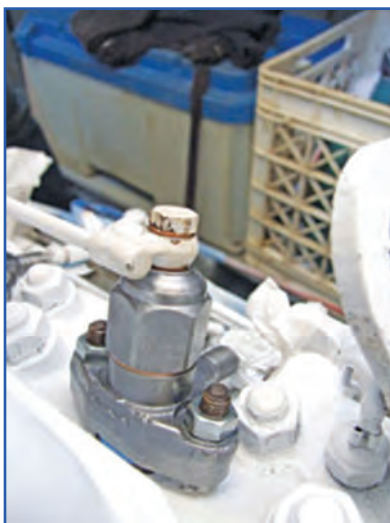
شکل ۵۴-۴- مراحل بستن انژکتور
