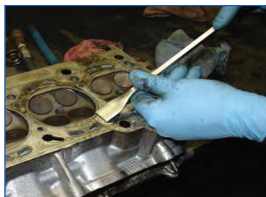
شکل ۴۲-۴- واشر سرسیلندر چسبیده به سیلندر
