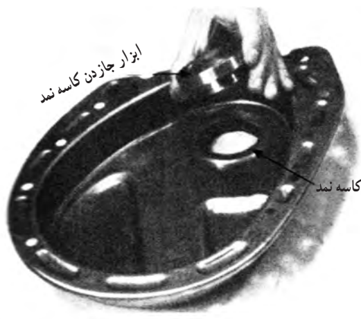
شکل ۴۳-۷- نحوه جازدن کاسه نمد روی سینی جلو
