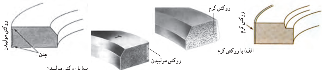
شکل ۲۴-۲- مقطع رینگ‌های تراکم روکش‌دار
