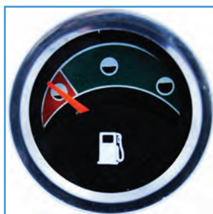
شکل ۹-۲- درجه نشان‌دهنده مقدار سوخت در مخزن سوخت
