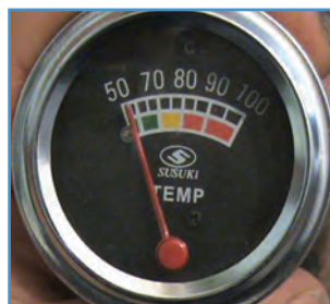
شکل ۱۰-۲- درجه نشان‌دهنده دمای آب
