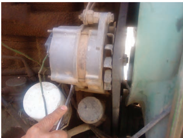
شکل ۳۹-۶ سفت کردن پیچ پایه
