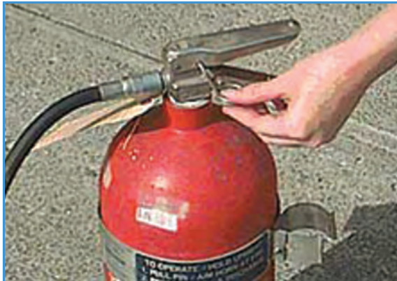
شکل ۱۱-۱- نحوه خارج کردن ضامن کپسول
