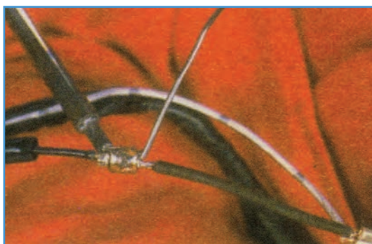
شکل ۶۴-۶- نحوه لحیم کاری سیم‌ها
