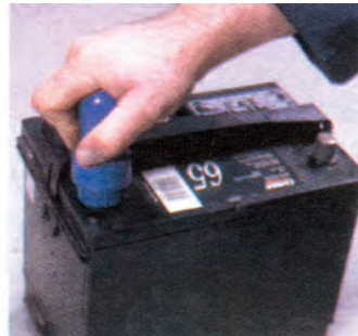
شکل ۲۳-۶- تمیز کردن قطب‌های باتری با ابزار مخصوص
