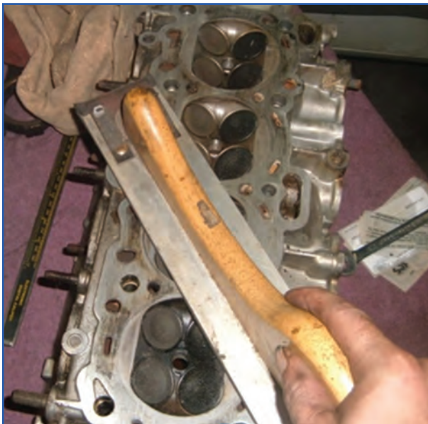
شکل ۴۴-۴- تمیز کردن سرسیلندر با سوهان نرم
