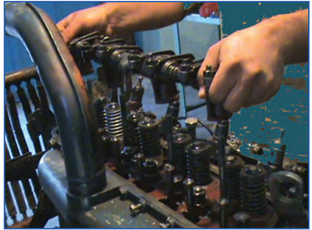
شکل ۹-۴- برداشتن محور اسبک و اسبک‌ها تراکتور U650
