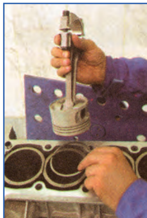
شکل ۱۲۷-۴- طرز قرار دادن رینگ داخل سیلندر
