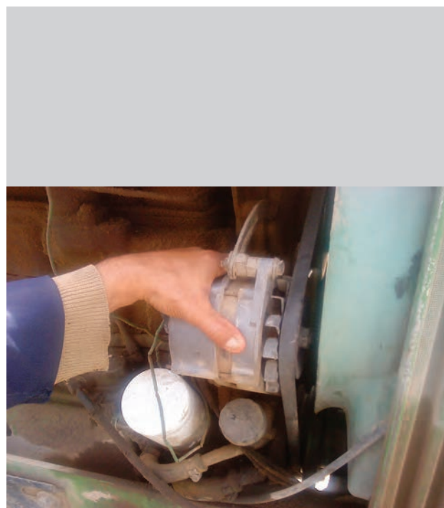
شکل ۳۷-۶ عقب کشیدن آلترناتور
