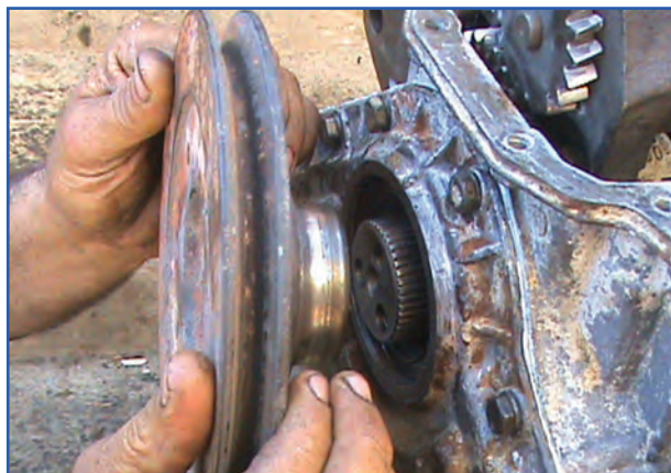
شکل ۴۶-۷- جازدن چرخ تسمه سر میل لنگ
