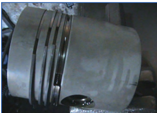
شکل ۱۳۹-۴- ترتیب قرار گرفتن رینگ‌ها روی شیار پیستون
