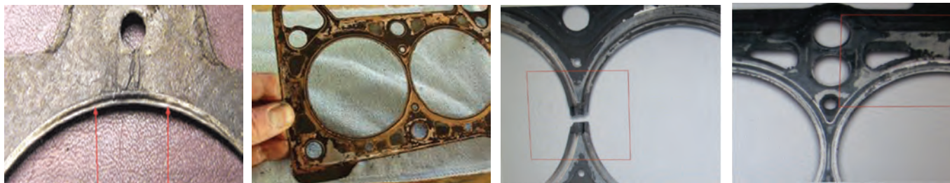
شکل ۵۰-۴- نواحی سوخته شده واشر سیلندر
