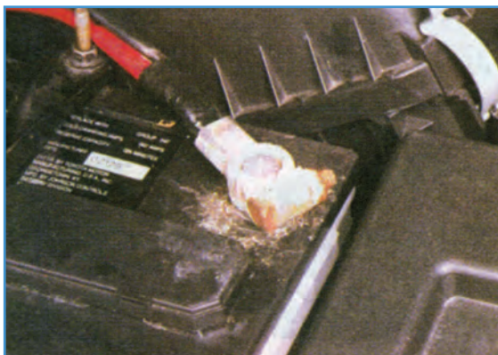
شکل ۲۱-۶- سولفاته کردن بست مثبت باتری
