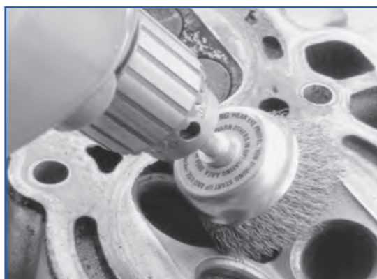
شکل ۴۱-۴- تمیز کردن اتاق احتراق
