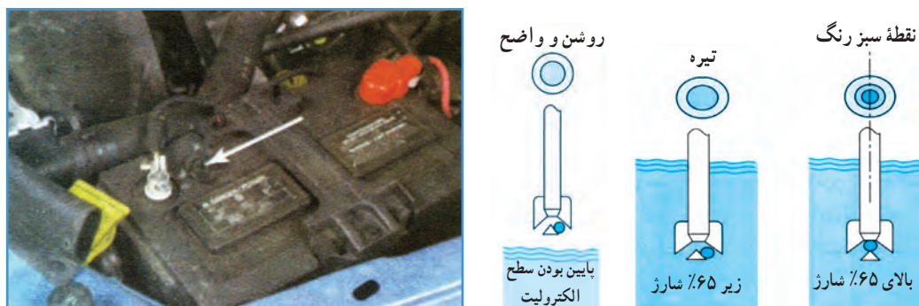
شکل ۳-۶- محل دریچه شیشه‌ای در باتری خشک و طرز تعیین شارژ یا دشارژ بودن باتری توسط آن
