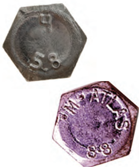
شکل ۱۵-۳ اعداد حک شده روی سر پیچ
