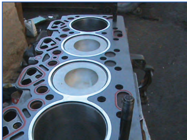
شکل ۵۲-۴- قرار دادن واشر سرسیلندر روی بدنه سیلندر
