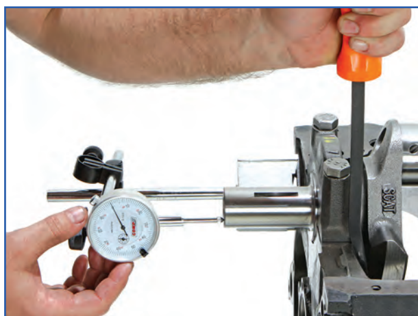
شکل ۱۷۹-۴- اندازه‌گیری لقی طولی میل‌لنگ با ساعت اندازه‌گیری
