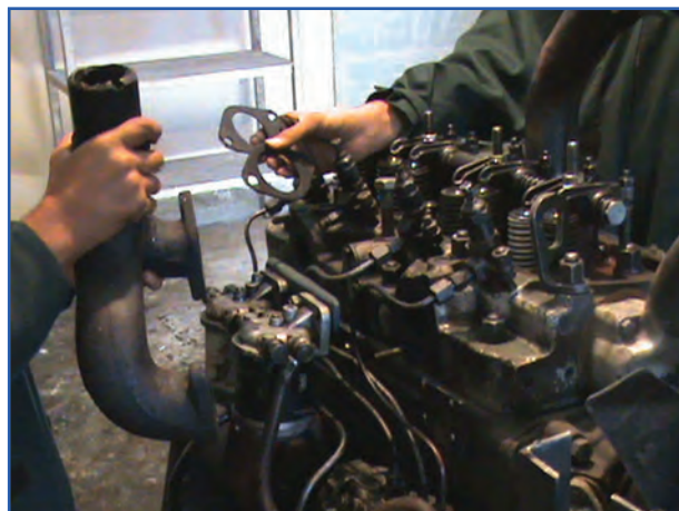
شکل ۴-۴- باز کردن مانیفلد هوا
