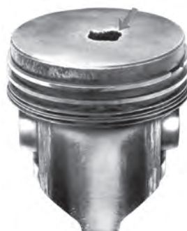
شکل ۴-۱۰۲- سوراخ شدن سر پیستون
