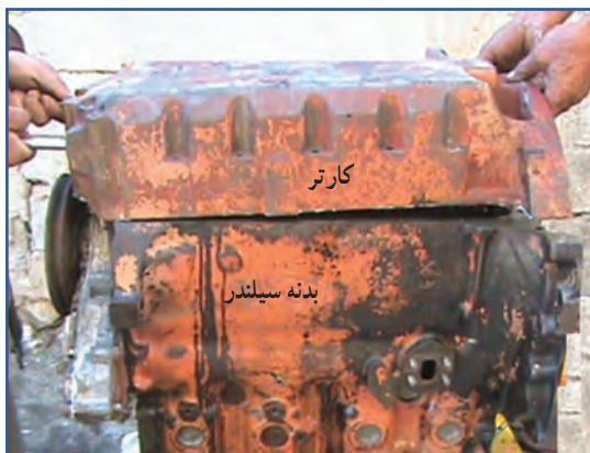
ب) برداشتن کارتر
