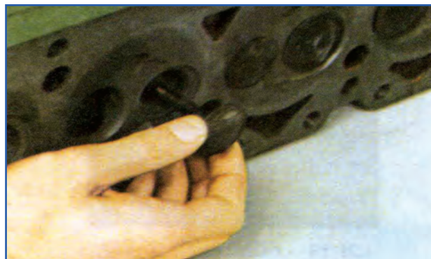
شکل ۲۳-۴- نحوه خارج کردن سوپاپ‌ها
