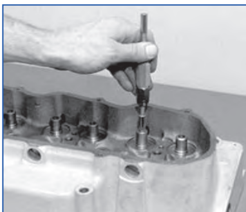
شکل ۴۰-۴- تمیز کردن گیت سوپاپ
