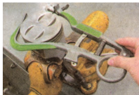
(ب) کاربرد ابزار تمیزکننده شیپار رینگ‌ها
