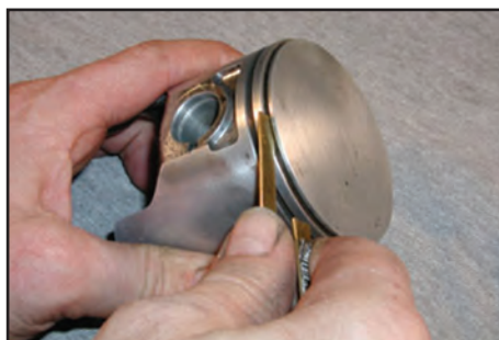
(د) تمیز کردن شیپار با ابزار برنجی
