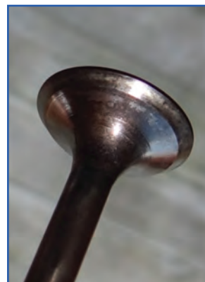
شکل ۴۵-۴- کربن گرفتن بشقابک سوپاپ
