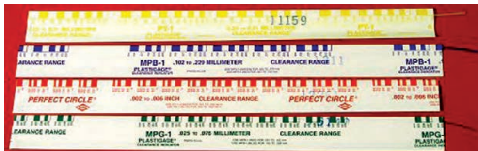
شکل ۱۷۸-۴- انواع پلاستیک گیج
