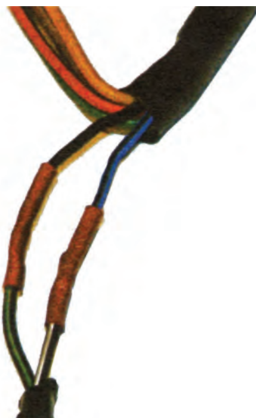
شکل ۶۷-۶- اتصال کامل سیم‌ها با روکش تیوب عایق
