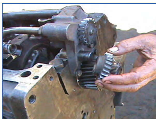
شکل ۸۰-۴- خارج کردن چرخ‌دنده بلمپ روغن
