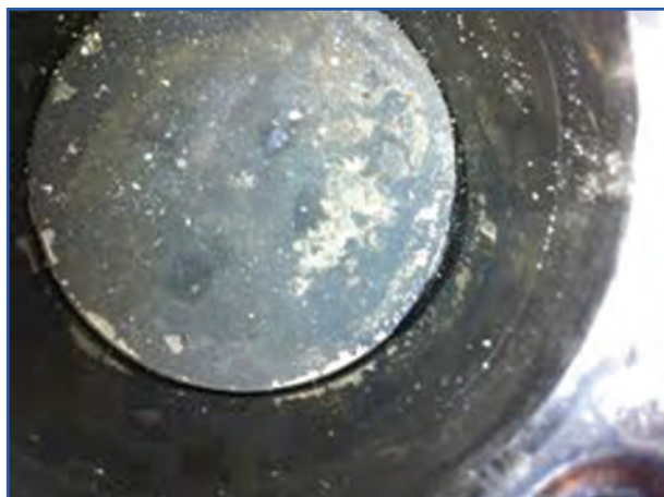
شکل ۲۰۶-۴- رسوبات کربن روی سطح پیستون
