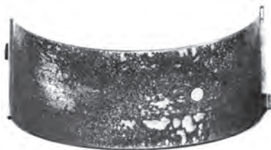
شکل ۱۶۸-۴- اثرات سوختگی روی یاتاقان
