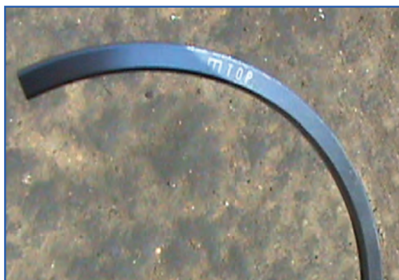
شکل ۱۳۴-۴- علامت TOP روی رینگ
