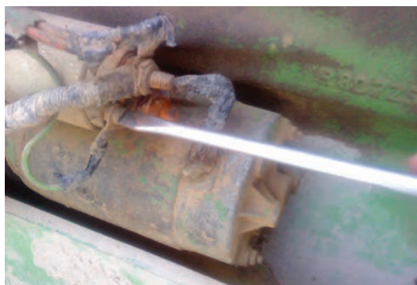
شکل ۴۹-۶ باز کردن فیش اتوماتیک استارت
