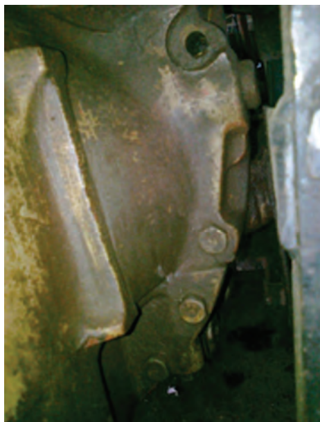
شکل ۱۱-۳- پیچ‌های اتصال موتور به جعبه‌دنده قسمت پایین
