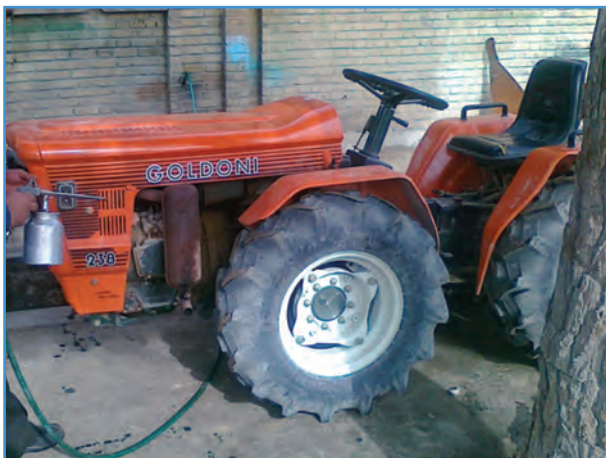
شکل ۱-۴- شستشوی موتور تراکتور با پیستوله شستشو
