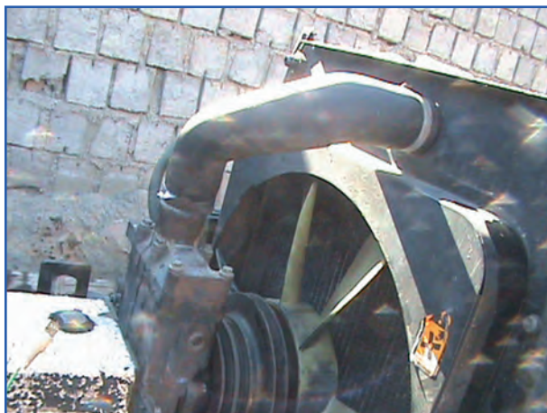
الف) باز کردن لوله لاستیکی رادیاتور
