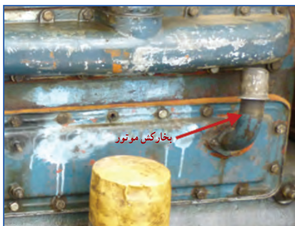
شکل ۲۶-۷- تهویه محفظه کارتر تراکتور U650M
