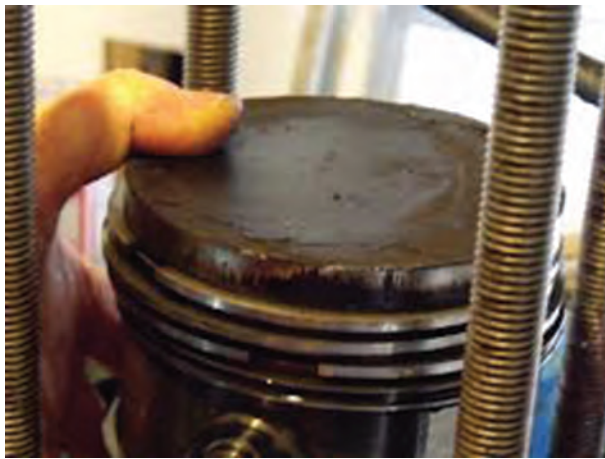
شکل ۲۰۷-۴- رسوبات کربن روی سطح پیستون
