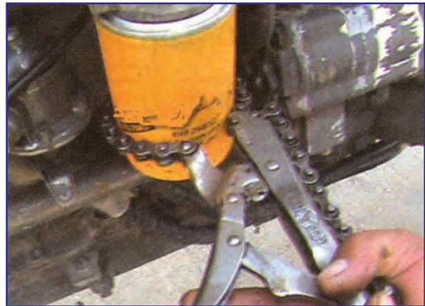
شکل ۱۶-۷- باز کردن صافی روغن با آچار مخصوص
