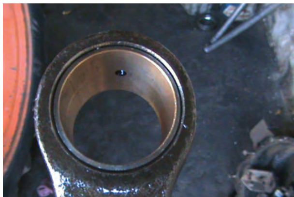
شکل ۱۲۰-۴ قرار گرفتن سوراخ بوش مقابل سوراخ شاتون
