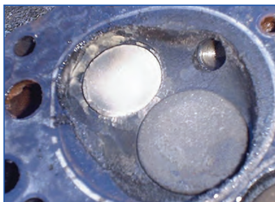
شکل ۴۱-۴- تمیز کردن اتاق احتراق
