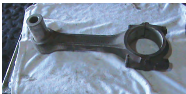
شکل ۱۲۱-۴ امتحان کردن انگشتی روی شاتون
