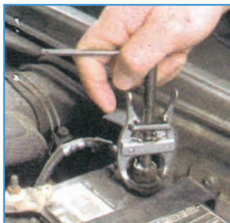
شکل ۶-۷ جدا کردن بست منفی باتری
