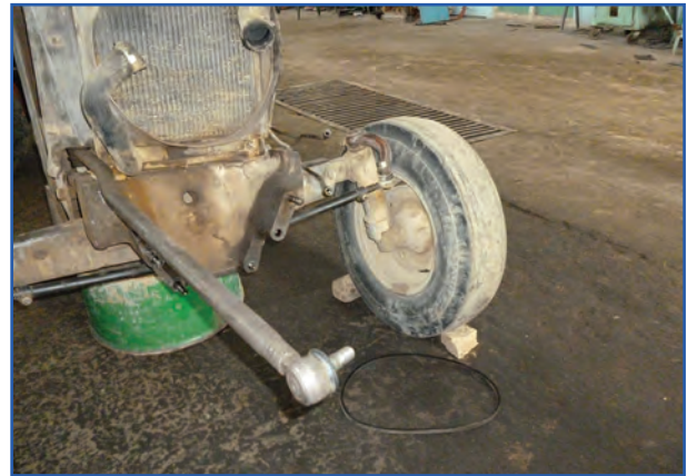
شکل ۱۹-۳- قسمت جلوی تراکتور جدا شده از موتور
