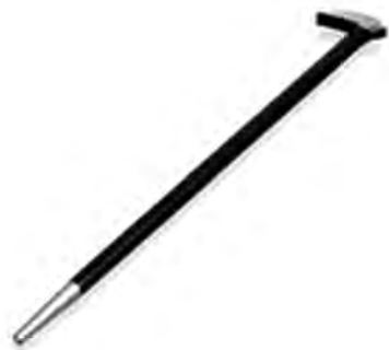
شکل ۷۲-۳- اهرم مخصوص خارج کردن انزکتور
