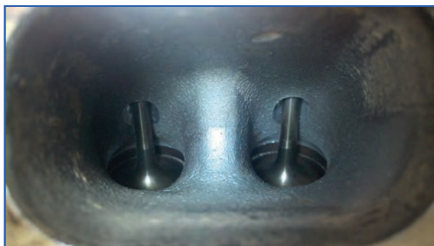
ب) محفظه تمیز پشت سوپاپ‌ها
