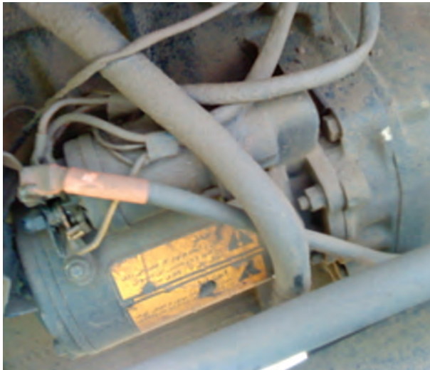
شکل ۶-۴۳- اتصال سیم‌ها از دینام به آف‌تامات
