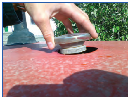
ب) باز کردن در رادیاتور
