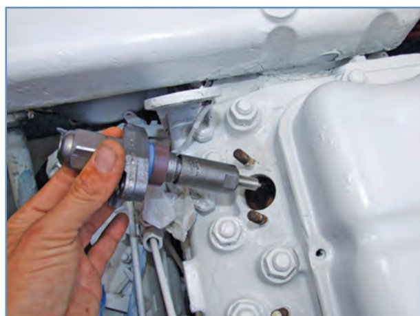
شکل ۲۳-۴- خارج کردن انژکتور
