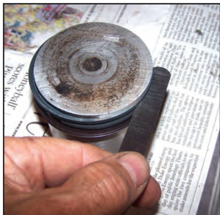
شکل ۹۳-۴- طرز اندازه‌گیری لقی رینگ در شیار رینگ‌ها با فیله
