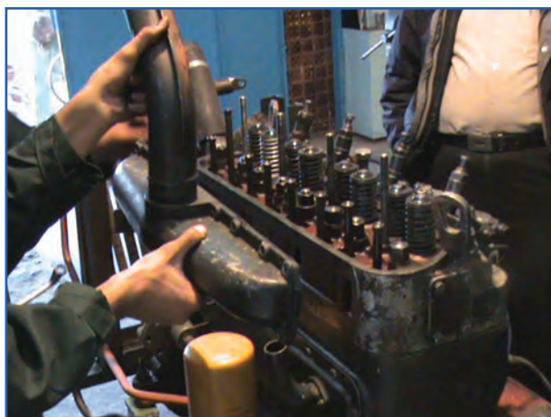
شکل ۴-۴- باز کردن مانیفلد هوا
