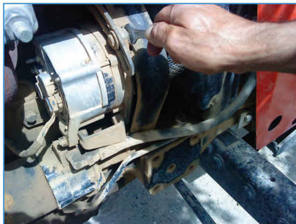
شکل ۲۹-۶ شل کردن پیچ و مهره تنظیم
