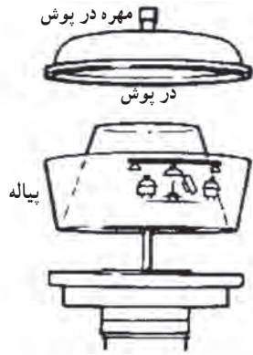
شکل ۳-۵ - قطعات پیش صافی
