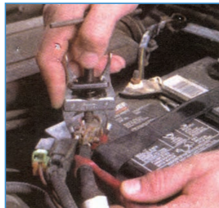
شکل ۸-۶- باز کردن بست مثبت باتری
