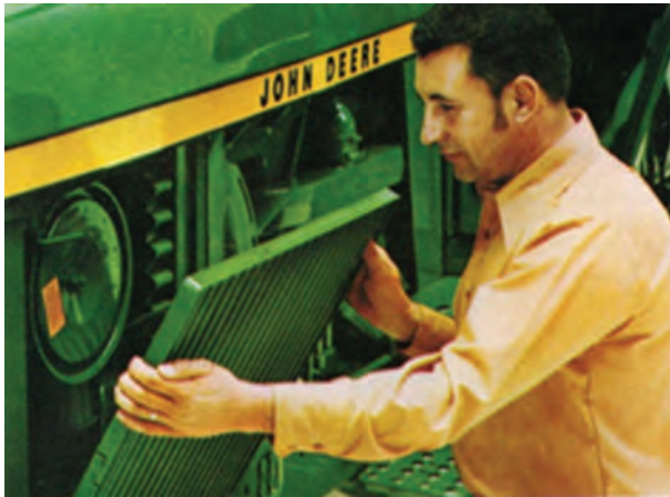
شکل ۱۰-۵ باز کردن شبکه بغل
