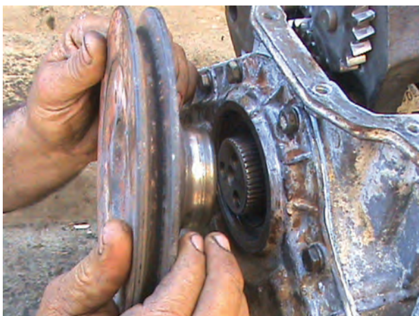
شکل ۴-۵۷- خارج کردن پولی میل لنگ
