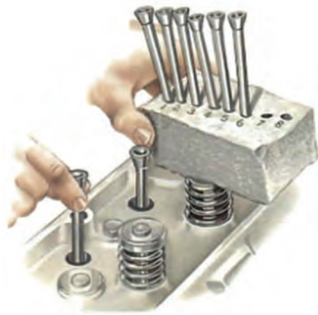
ب) به ترتیب قرار دادن میل تایپت
