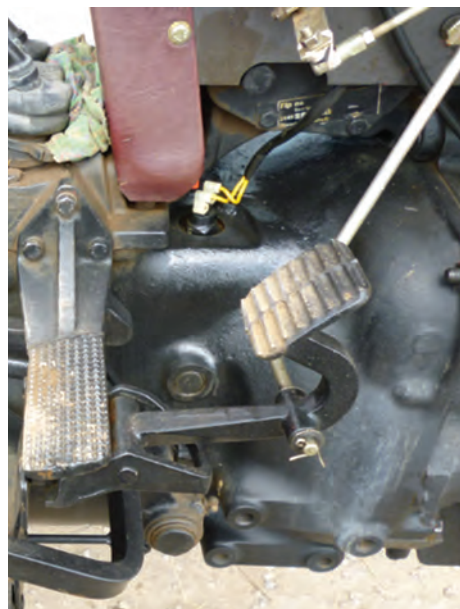
شکل ۱۱-۳- پیچ‌های اتصال موتور به جعبه‌دنده قسمت پایین
