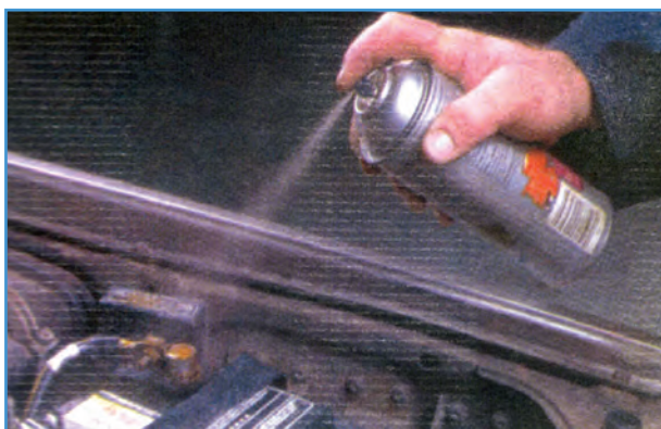
شکل ۱۱-۶- پاشیدن اسپری ضد خوردگی روی بست باتری
