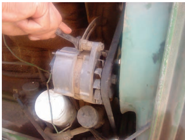
شکل ۳۸-۶ سفت کردن پیچ تنظیم آلترناتور
