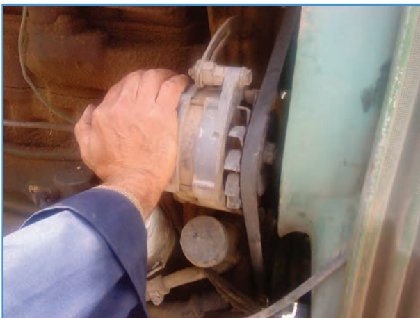
شکل ۳۰-۶ فشار دادن آلترناتور به عقب
