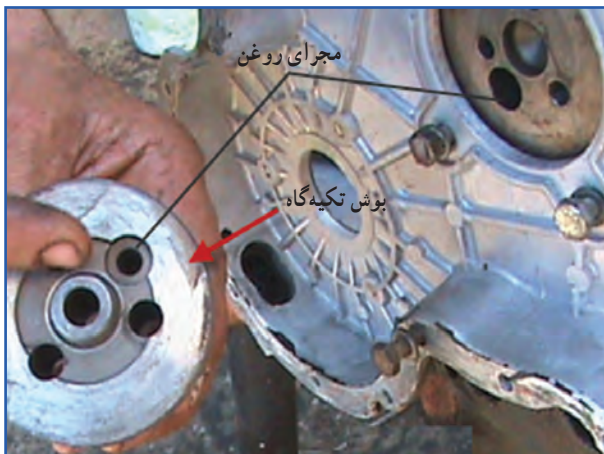
شکل ۶۸-۴ خارج کردن بوش تکیه‌گاه چرخ‌دنده واسط
