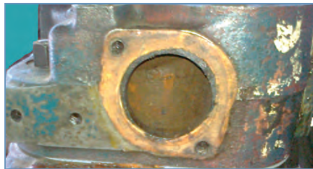
شکل ۲۳-۳ - واشر ترموستات قبلی
