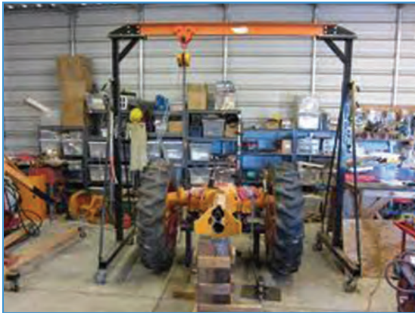
شکل ۲۴-۴ کاربرد جرثقیل دروازه‌ای متحرک
