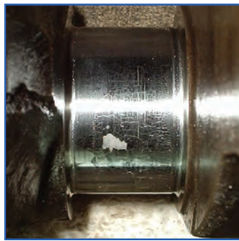
ب) پوسته کردن لایه سخت لنگ
