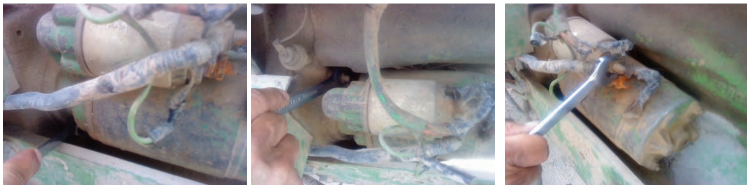
شکل ۵۰-۶ باز کردن کابل مثبت از استارت
