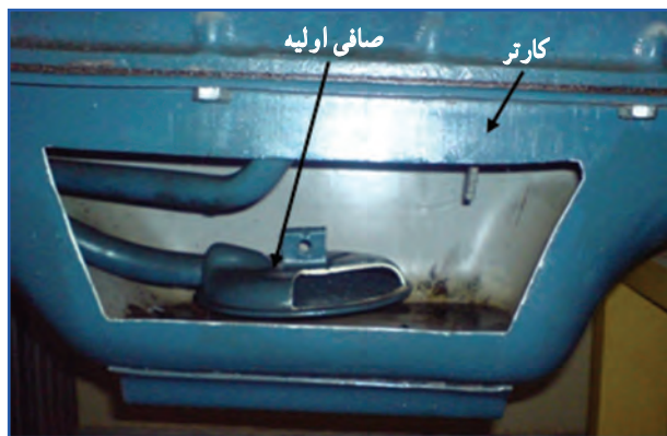
شکل ۲۴-۷- کارتر برش خورده تراکتور U650
