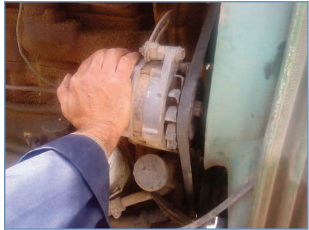
شکل ۳۰-۳- فشار دادن مولد به سمت موتور
