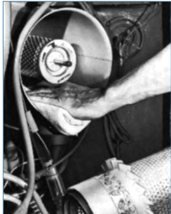
شکل ۱۳-۵ تمیز کردن بدنه صافی با پارچه
