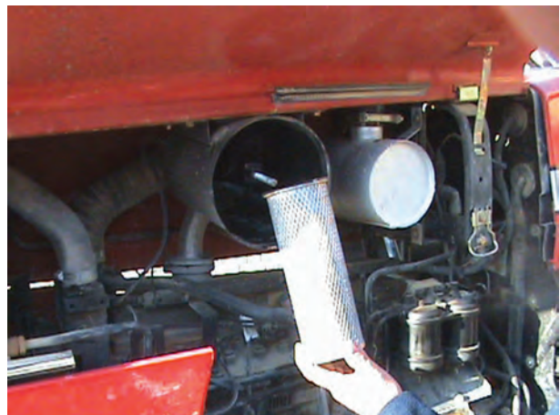
(الف) خارج کردن صافی ثانویه
