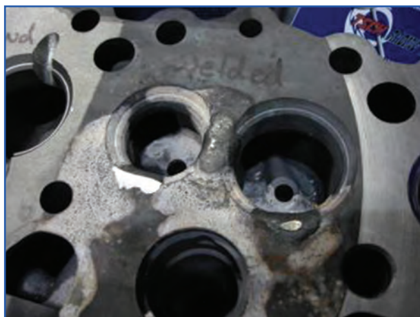
شکل ۲۶-۴- ترمیم ترک سرسیلندر با جوشکاری
