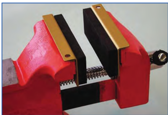
شکل ۳-۴- کاربرد پیچ در گیره برای جابه‌جایی فک متحرک
