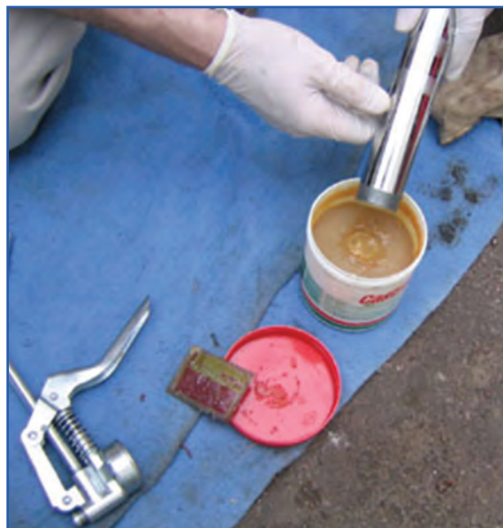
شکل ۴۸-۷- مراحل پر کردن گریس پمپ دستی
