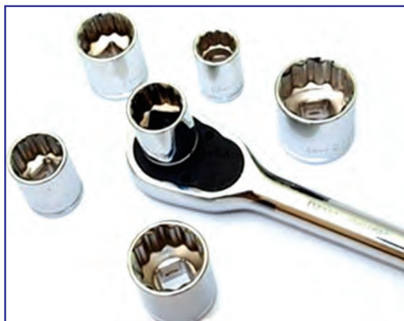
شکل ۴۸-۳- اتصال بکس به دسته بکس جفجغه ای
