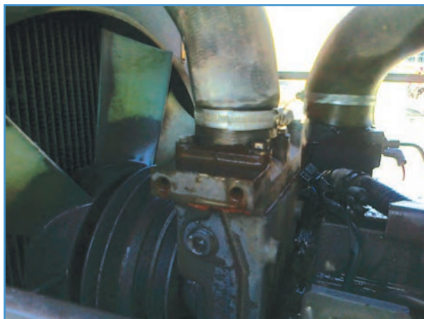
شکل ۱۱-۳- محل بست شیلنگ محفظه ترموستات
