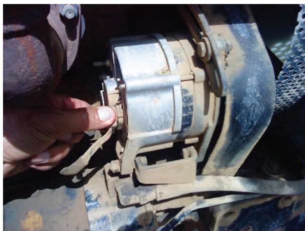
شکل ۲۸-۶- جدا کردن فیش از آلترناتور
