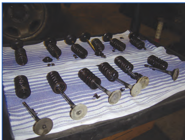
(الف) اجزای باز شده سوپاپ
