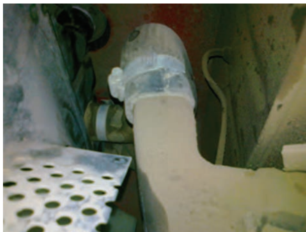
شکل ۱۵-۳- اتصال شیلنگ رادیاتور
