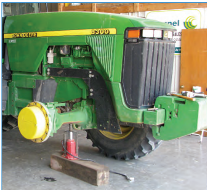
شکل ۱۱-۴- قرار دادن جک روغنی زیر جسم سنگین
