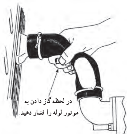
شکل ۲۰-۳- نحوه فشار دادن شیلنگ بالای رادیاتور
