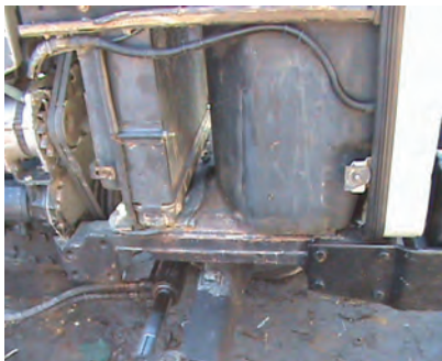
و) باز کردن بست نگهدارنده باک
