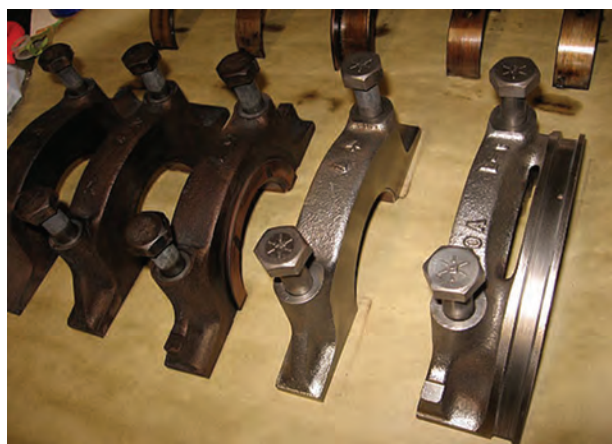
شکل ۱۵۴-۴- چیدن کپه یاتاقان‌ها
