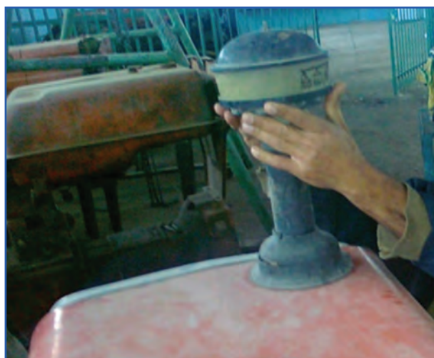
شکل ۲-۳- باز کردن پیش صافی
