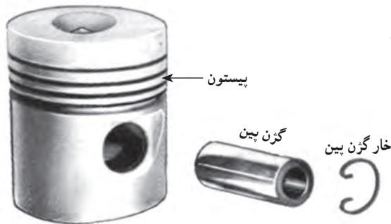
شکل ۳۰-۲- انگشتی و محل نصب آن روی پیستون
