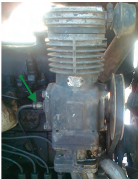
شکل ۵-۸- لوله روغن کاری کمپرسور در تراکتور U650
