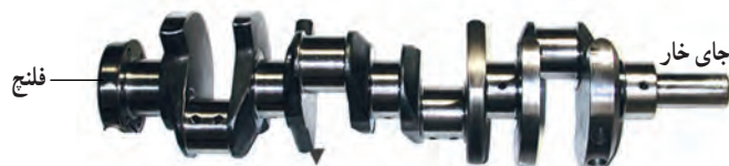
شکل ۳۵-۲ محل فلنج و جای خار روی میل لنگ
