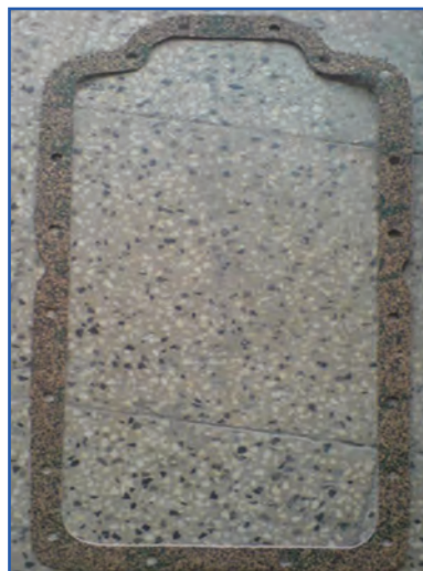
الف) واشر کارتر ویکتوری MF285
