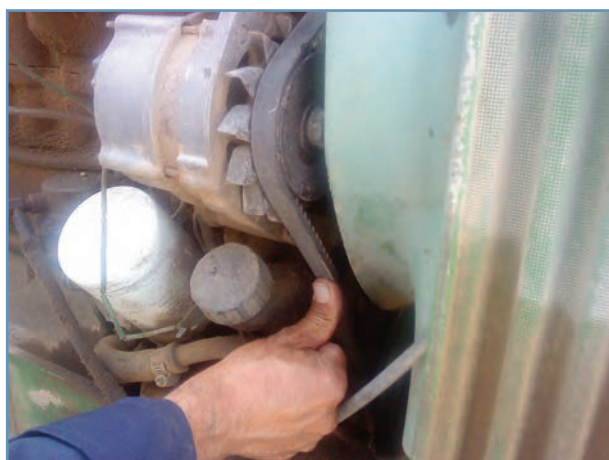
شکل ۳۶-۶ فشار دادن تسمه با شست
