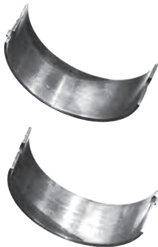
شکل ۱۶۹-۴- وضعیت ساییدگی یاتاقان به دلیل کج قرار گرفتن شاتون روی محور میل‌لنگ
