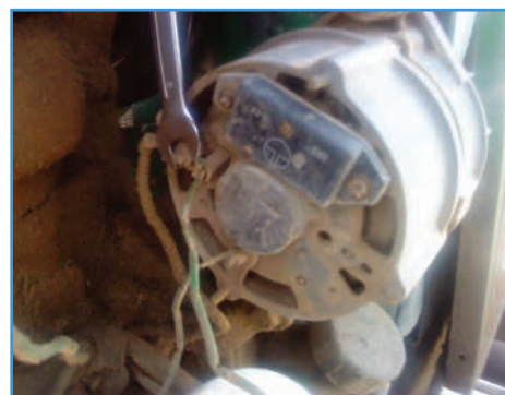
شکل ۳۳-۶ بستن سیم مثبت
