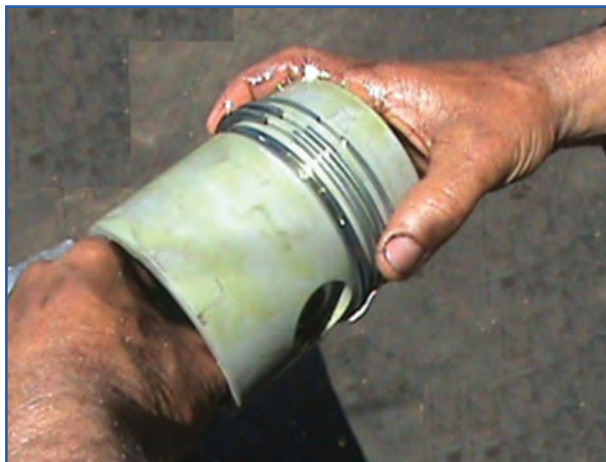
شکل ۱۹۶-۴- تنظیم کردن دهانه رینگها
