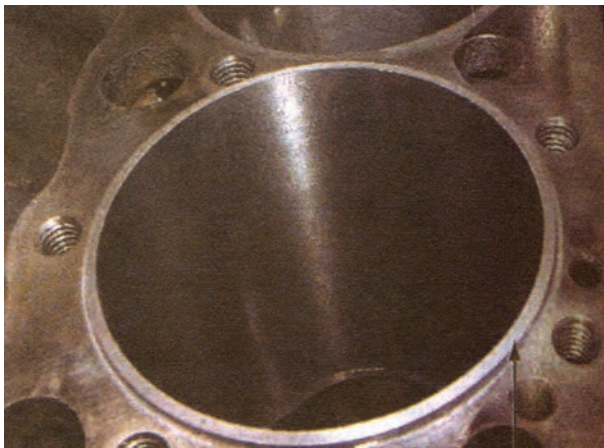
شکل ۱۴۴-۴- لبه بوش به طور کامل جا افتاده است.
