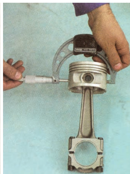
الف) اندازه‌گیری قطر دامن پیستون
