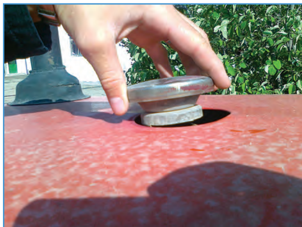
شکل ۳-۷- باز کردن در رادیاتور تراکتور MF285
