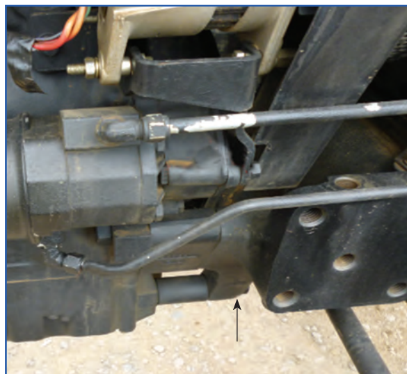
شکل ۱۷-۳- محل پیچ‌های اتصال موتور به جلوی تراکتور
