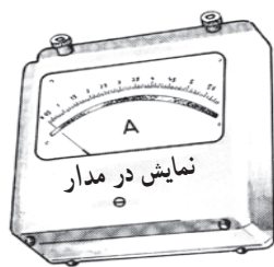
شکل ۲۹-۵ شکل ظاهری آمپر متر
