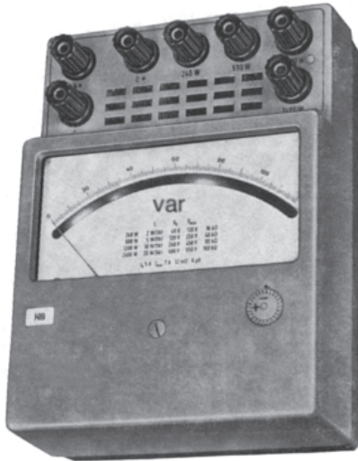
شکل ۳۷-۵- شکل ظاهری وارمتر
