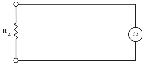
شکل ۳۱-۵ طرز قرارگیری مقاومت با اهم متر
