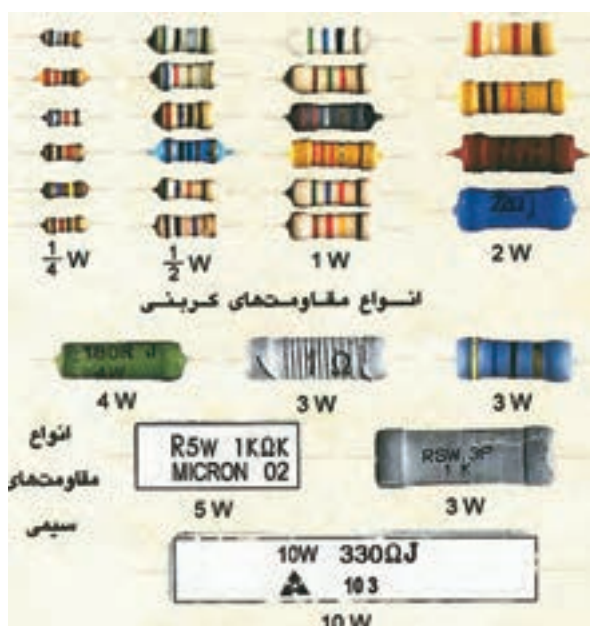
شکل ۱۷-۶- استانداردهای توان در مقاومت ها
