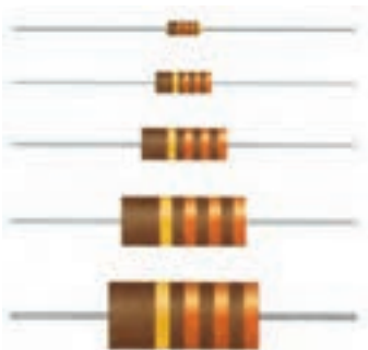
(الف) مقاومت لایه کربن
