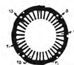
شکل ۷۹- ورق هسته الکتروموتور کولر و شیار شروع سیم پیچ
