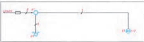
شکل ۱۴- شمای فنی مدار کلید دوبل
