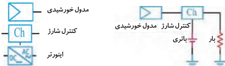
شکل ۹- شمای فنی سامانه فتوولتائیک
