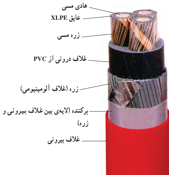
شکل ۵-۷- کابل با غلاف آلومینیومی
