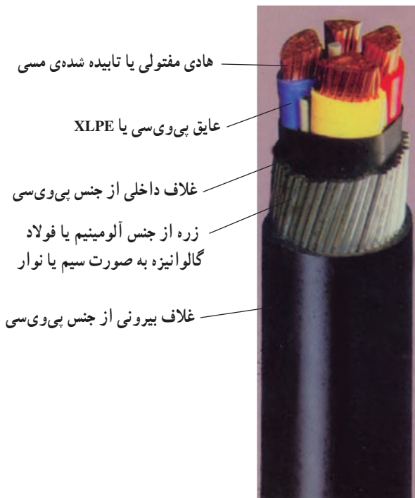
شکل ۴-۵- کابل با عایق PVC به همراه اجزای کابل
