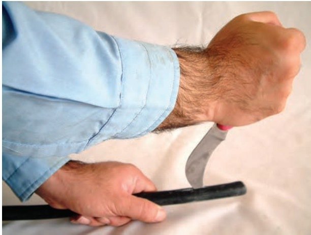
شکل ۵-۳۳- طریقه‌ی صحیح روکش برداری کابل
