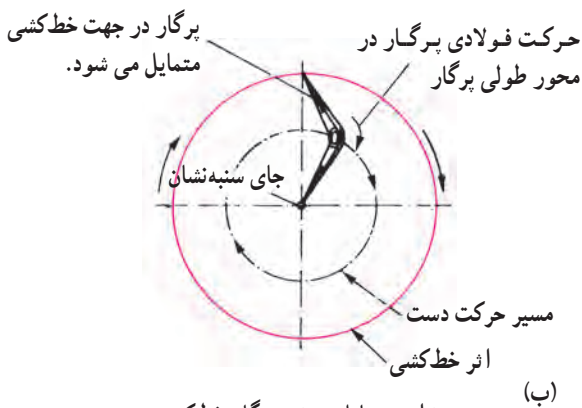
زاویه تمایل سوزن پرگار خط‌کشی
