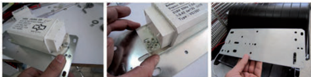
شکل ۲-۳۹ - نحوه نصب بالاست در نورافکن
