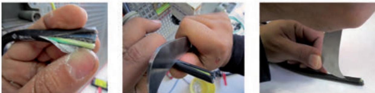
شکل ۲-۲۲ - بریدن و لخت کردن کابل
