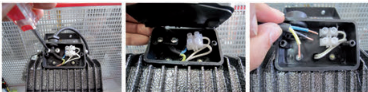
شکل ۲-۲۵ - سیم کشی در جعبه اتصالات
