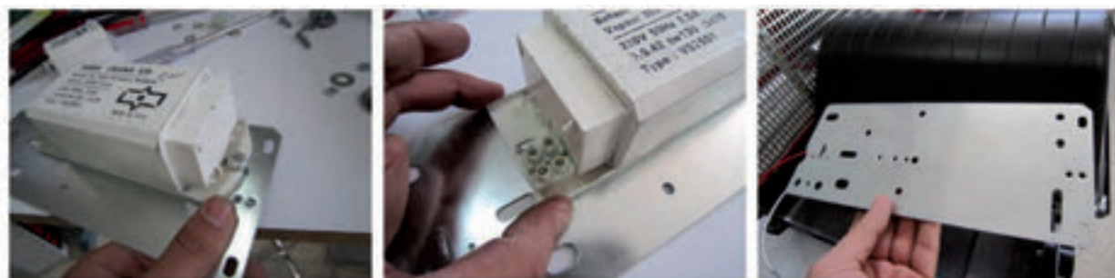
شکل ۲-۳۹ - نحوه نصب بالاست در نورافکن
