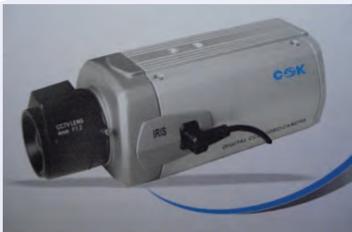
شکل ۳-۲۲ اتصال کابل لنز اتوایریز به دوربین
