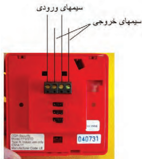
شکل ۳۹-۱ سیم‌های اتصال شستی
