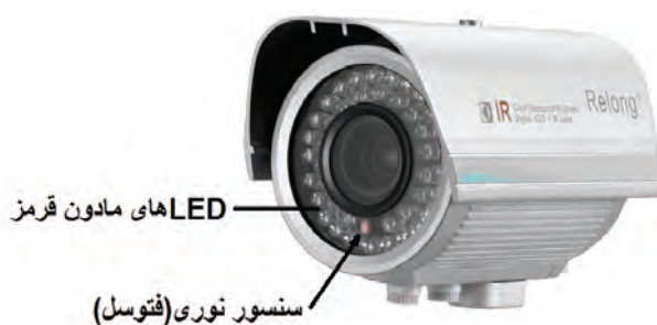
شکل ۳-۹ لامپ (LED) های تولید کننده نور مادون قرمز
