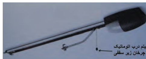
شکل ۴-۲۶ خلاص کن درهای اتوماتیک مختلف
