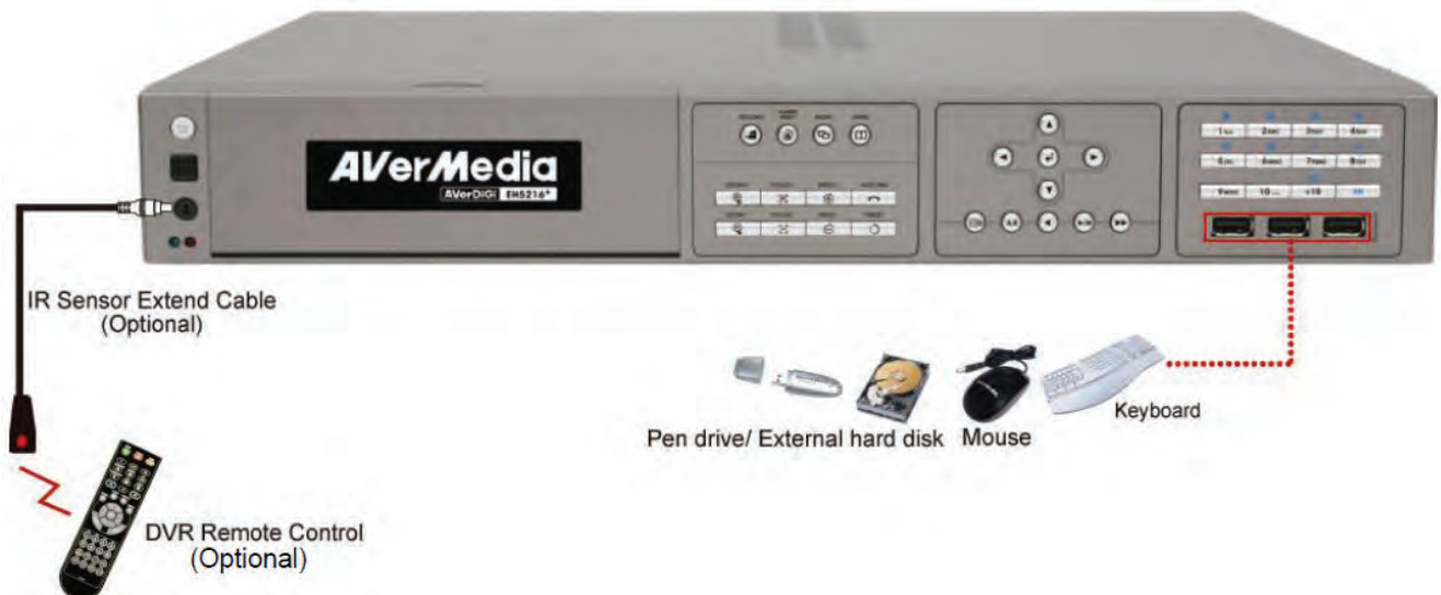
شکل ۷۱-۳ محل اتصال تجهیزات جانبی به دستگاه ضبط کننده
