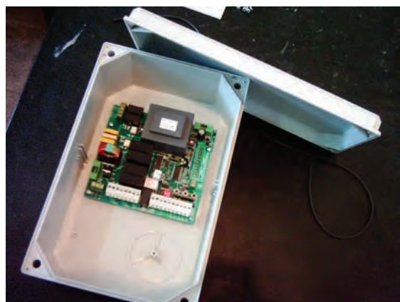
شکل ۱۷-۴ برد الکترونیکی در اتوماتیک لولایی
