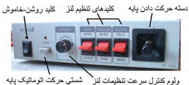
شکل ۳-۵۵ قسمت‌های مختلف جلو کنترل‌کننده
