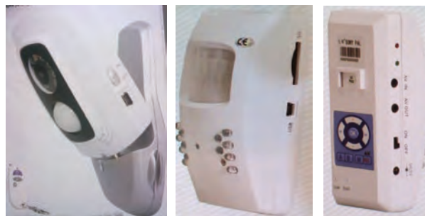
شکل ۳-۱۵ دوربین‌ها با حافظه داخلی
