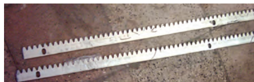
شکل ۴-۳۲ دنده های شانه ای
