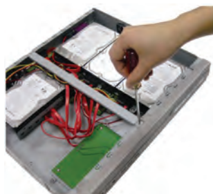
شکل ۶۸-۳ دیسک سخت نصب شده در داخل دستگاه
