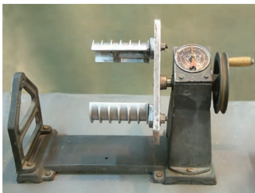
شکل ۳-۱۵- تنظیم اندازه‌ی قالب‌ها در کلاف پیچ
