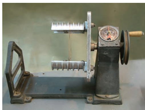
شکل ۳-۵- تنظیم قالب‌ها براساس اندازه‌ی کلاف
