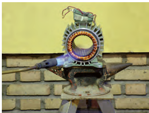
شکل ۲-۱۸- سوزاندن مستقیم سیم‌ها با شعله
