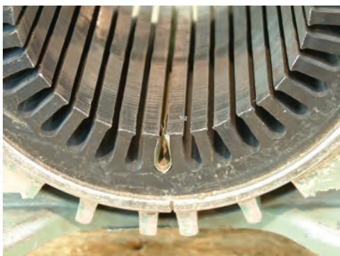
شکل ۲-۳۳- اندازه گیری محیط شیار
