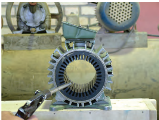
شکل ۱-۳۱ - بادگیری قطعات جدا شده
