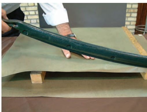
شکل ۲۹-۲ - کاتر یا دستگاه برش‌دهنده‌ی عایق‌های برشمان
