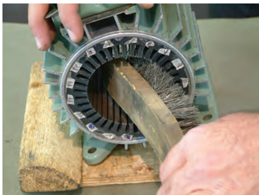
ب – تمیز کردن استاتور با برس سیمی
