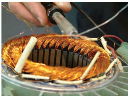
شکل ۴-۷ - لحیم کاری محل اتصال سیم ها
