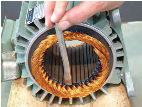
الف- قرار دادن قلم روی سیم‌ها
