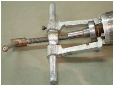
شکل ۴۶-۱ استقرار بلبرینگ کشر روی محور روتور
