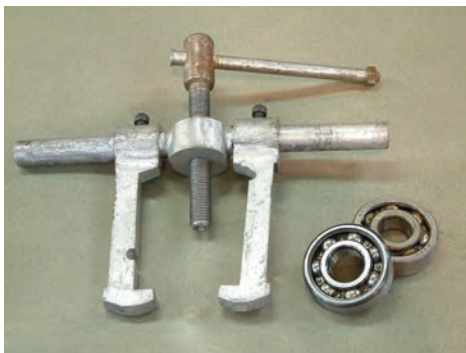
شکل ۴۷-۱ بلبرینگ‌ها پس از جدا شدن از محور
