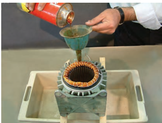
شکل ۴-۲۵- ریختن شارلاک روی سیم ها
