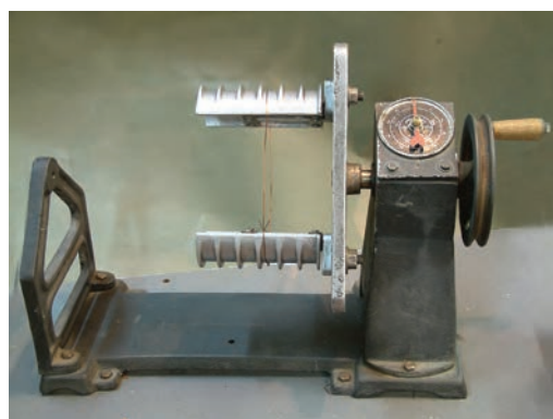
شکل ۳-۵- تنظیم قالب‌ها براساس اندازه‌ی کلاف
