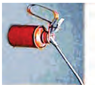
شکل ۱-۳۴- روغن کاری یاتاقان ها
