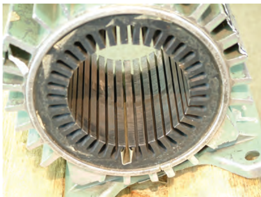
شکل ۲-۳۶ – آزمایش عایق در داخل شیار
