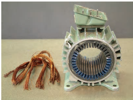
شکل ۲-۲۴ - سیم‌های بیرون آمده از استاتور
