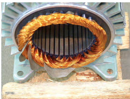
شکل ۲-۳۱- عایق کاری پیشانی کلاف‌ها
