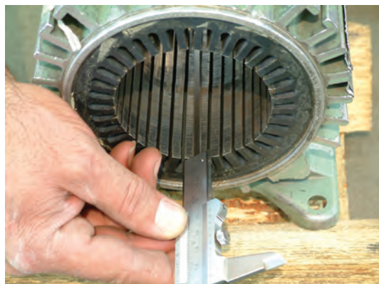
شکل ۲۶-۲- اندازه گیری محیط داخلی و طول شیار
