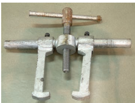
شکل ۴۸-۱ ابزار درآوردن بوش و یاتاقان‌های استوانه‌ای
