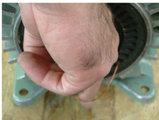
شکل ۳-۴- تعیین حدود قالب از طریق گام سیم‌بندی
