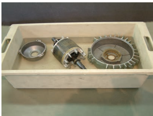
شکل ۱-۳۲ - شست و شوی قطعات با آب گرم
