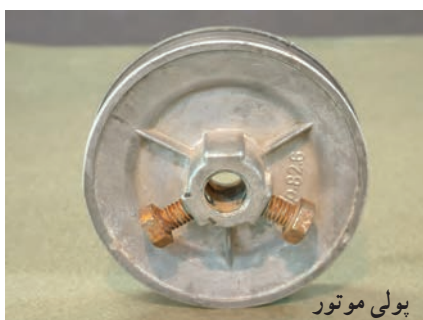
شکل ۱-۲۵- باز کردن پولی موتور
