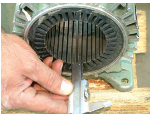
شکل ۲-۳۲- اندازه گیری طول شیار
