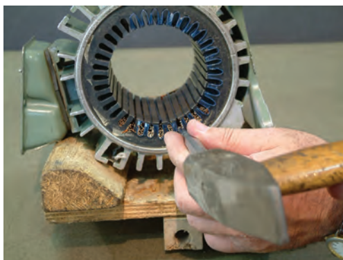
شکل ۲-۲۳ - هدایت سیم ها به طرف دوم استاتور
