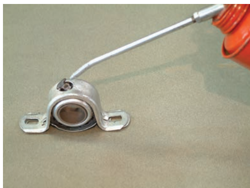
شکل ۱-۳۴- روغن کاری یاتاقان ها
