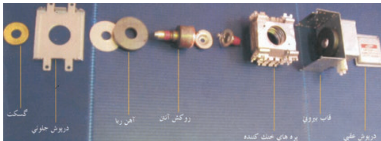
شکل ۳-۹۶ نقشه ی انفجاری قطعات یک مگنترون
