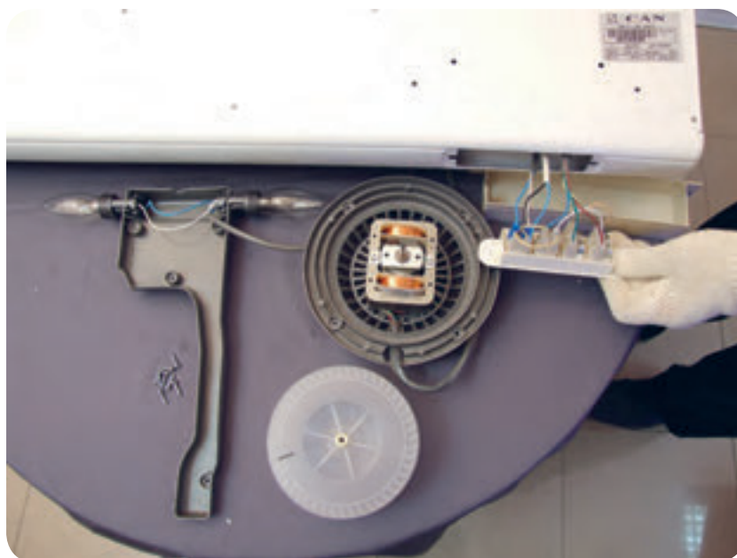
شکل ۱-۲۳ نقشه انفجاری هود آشپزخانه (دید از بالا)
