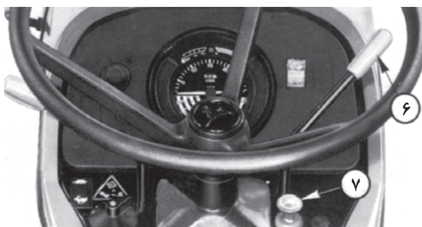
شکل ۷ — اهرم گاز دستی — ۷ — اهرم خاموش کن
