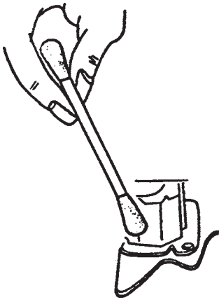
شکل ۵-۵۳- هد صوتی را با استفاده از الکل و وسیله‌های پاک‌کننده تمیز کنید.
