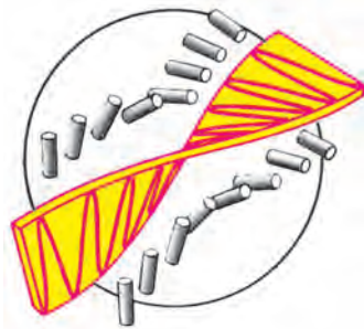
شکل ۶-۵۸- خم شدن مولکول‌های کریستال مایع مطابق جهت تابش نور
