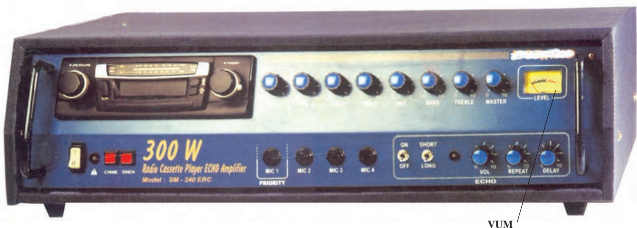
شکل ۱-۳- ابزار سنجش VUM در یک آمپلی فایر
