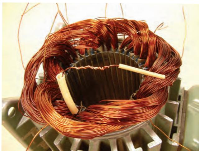
شکل ۳-۷- سیم‌های خروجی از شیارهای ۱۲ و ۱۹ را روی هم قرار داده و هر کدام را به اندازه یک سانتی‌متر روی دیگری بتابانید (شکل ۳-۷).
