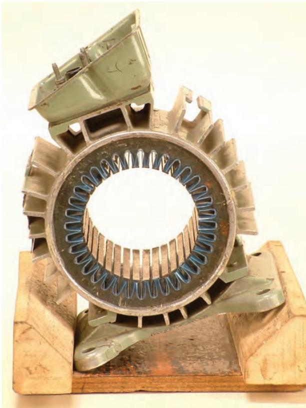
شکل ۲-۲-ب - انتخاب شیار شروع سیم‌بندی
