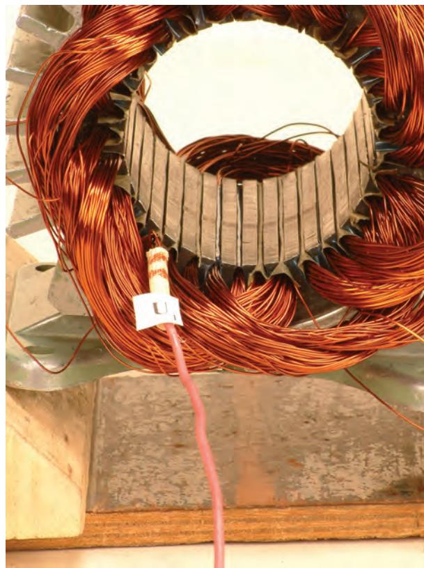
شکل ۳-۱۱- اتصال سیم افشار به ابتدا و انتهای فاز و برچسب زدن آن
