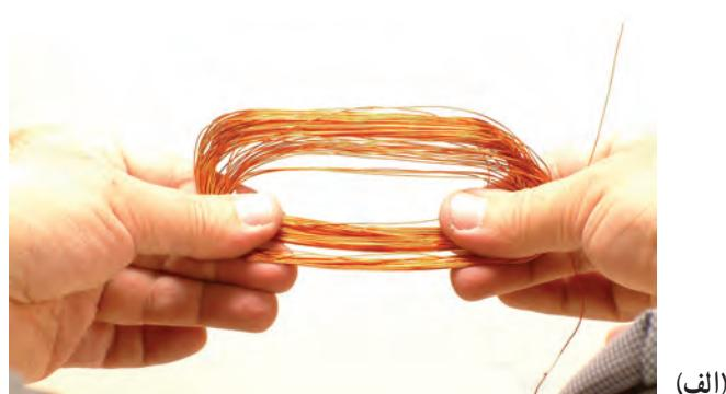
کلاف‌ها، مطابق قسمت الف شکل ۲-۳ بین انگشتان قرار می‌گیرند. سیم‌ها را مطابق قسمت ب شکل ۲-۳ مرتب کرده و آن‌ها را به شیارها هدایت کنید. به این ترتیب، از مورب قرارگرفتن سیم‌ها بر روی هم جلوگیری شده و از فضای داخل شیار، به‌طور کامل استفاده می‌شود.
