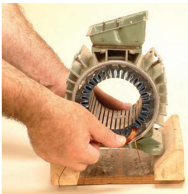
۷- پس از قراردادن بازوی دوم کلاف شماره یک، پیشانی‌های آن را در جهت سیم پیچی خم کنید تا جای کافی برای بازوهای بعدی فراهم شده و براحتی در داخل شیارها قرار بگیرند. این عمل را برای همه کلاف‌ها پس از جازدن آن‌ها اجرا می‌کنیم (شکل‌های ۲-۱۷).
