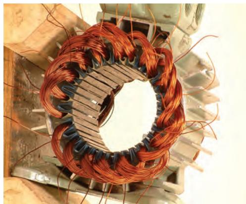
۱۲- قبل از قراردادن کلاف شماره ۱۷، هر دو بازوی موجود در شیار ۱ و ۳ را از شیارهای مربوطه خارج کرده و به سمت بالا خم کنید (شکل ۲-۳۵).
