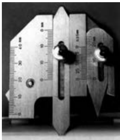
شکل ۳- ابزار اندازه گیری بعد جوش
