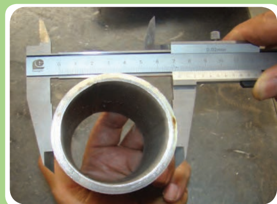
اندازه گیری قطر خارجی لوله توسط کولیس
