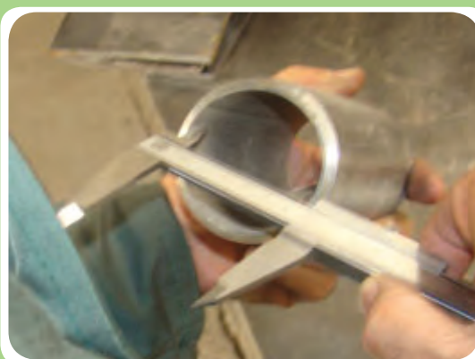
اندازه گیری قطر داخلی لوله توسط کولیس
