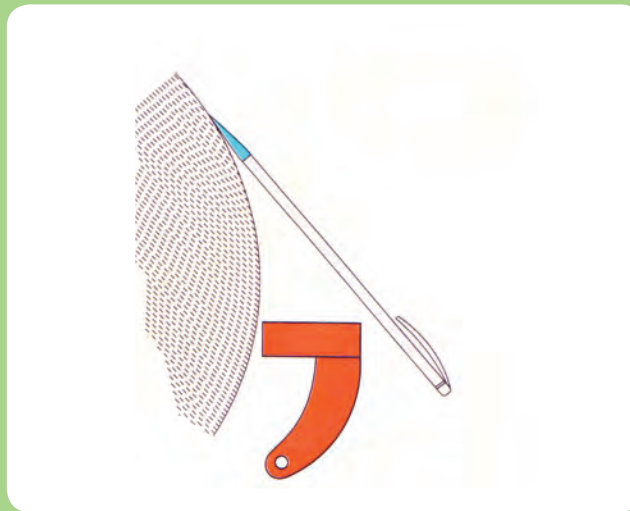
تیز کردن سوزن خط کش
