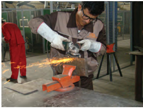
تشخیص نوع فولاد بر اساس آزمایش جرقه
