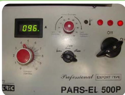
صفحه کلید دستگاه های جوشکاری و کلید های مخصوص تغییر شدت جریان
