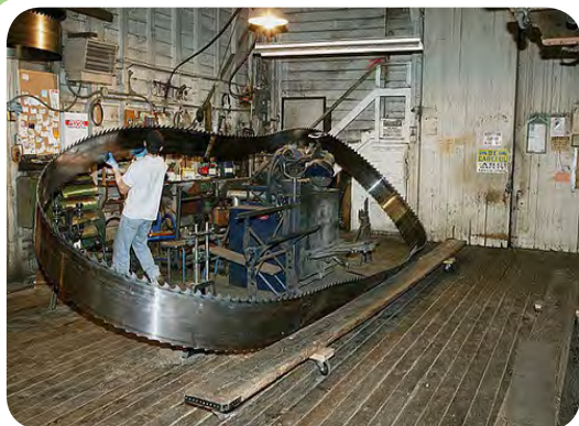
دستگاه اره نواری که برای برش قطعات فلزی و چوبی استفاده می‌شود
