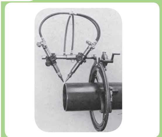
برشکاری و پخ‌سازی لوله فولادی به‌طور هم‌زمان
