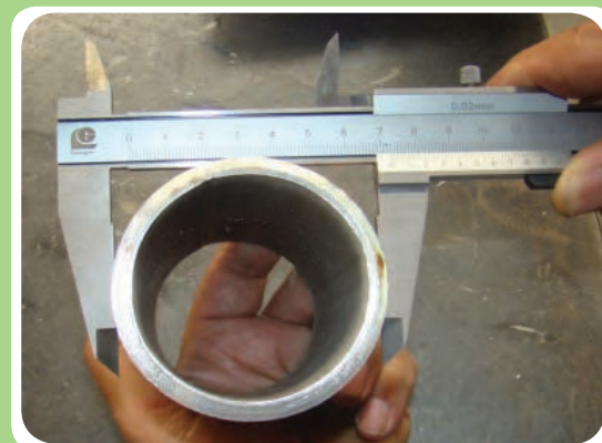
اندازه گیری قطر خارجی لوله توسط کولیس
