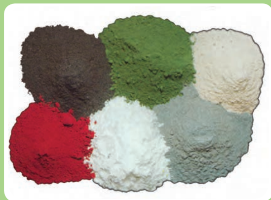
مواد پودری تشکیل دهنده روپوش الکتروود
