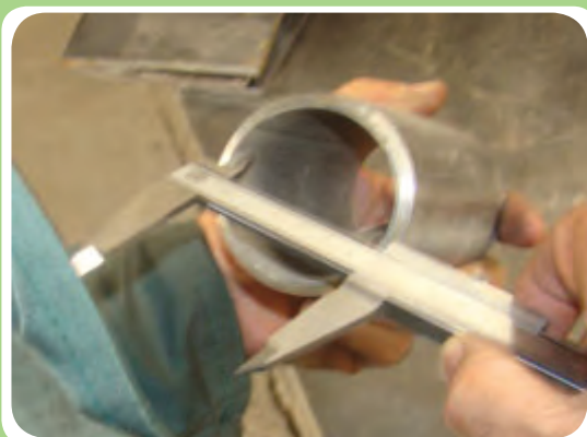
اندازه گیری قطر داخلی لوله توسط کولیس
