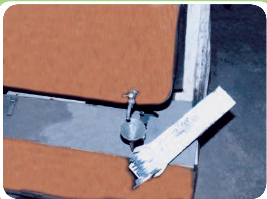
قرار دادن الکترودها در محل نامناسب خطر آغشته شدن به مواد آلوده کننده را زیاد می‌کند.
