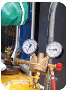
محکم کردن اتصالات رگولاتور به کپسول گاز
