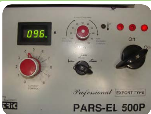
صفحه کلید دستگاه های جوشکاری و کلید های مخصوص تغییر شدت جریان
