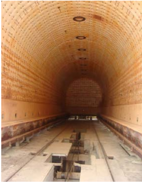
کوره عملیات حرارتی صنعتی با ابعاد بزرگ
