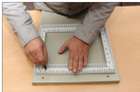
شکل ۴۱- داکت کشی روی صفحه نصب
