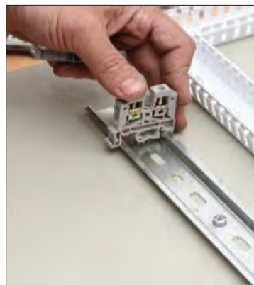
شکل ۴۷- نصب ترمینال‌های ریلی ورودی و خروجی و شینه‌های زمین
