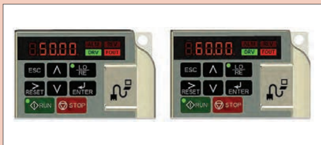
شکل ۵- دو فرکانس مختلف اینورتر
