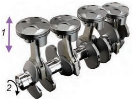
شکل ۱۹- کاربرد مکانیزم لنگ و لغزنده در موتور
