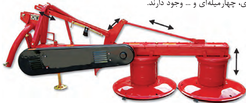
شکل ۴- مکانیزم میله‌ای در دروگر
