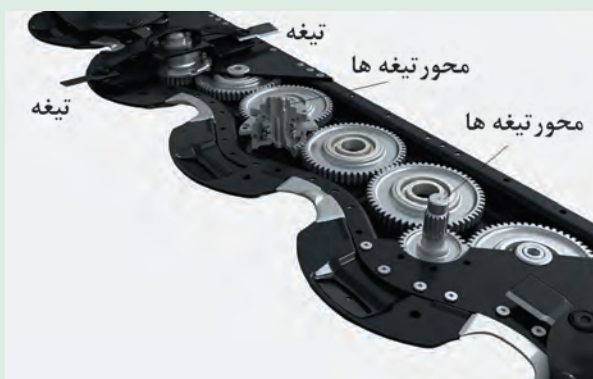
شکل ۵۱ - چرخ دنده‌های محرک تیغه‌ها در دروگر بشقابی
