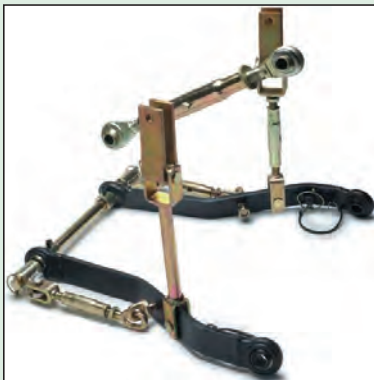
شکل ۶- میله‌ها و مفصل‌های اتصال سه نقطه تراکتور
