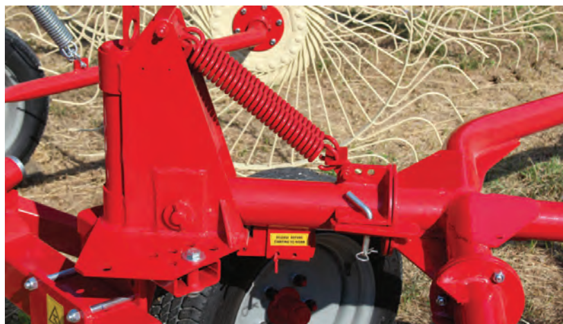
شکل ۱۵- مکانیزم شناوری شانه خورشیدی
