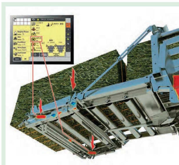
شکل ۴۹- کاربرد لودسل در بسته‌بند مکعبی
