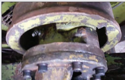
شکل ۴۸- پیچ‌های اتصال کلاچ به یوک چهارشاخه گاردان
