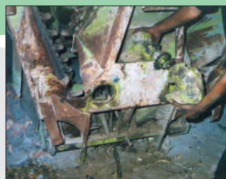
شکل ۲۴- برداشتن جعبه‌دنده دوقلو
