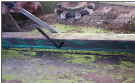
شکل ۲۰- باز کردن راهنمای زنجیر
