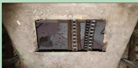
شکل ۲۶- درپوش روغن کاری زنجیر محرک واحد درو
