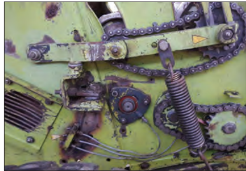
شکل ۳۷- فنر شناوری غلتک‌های بالایی
