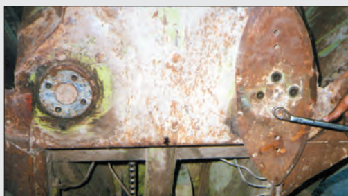
شکل ۳۱- باز کردن تیغه متحرک
