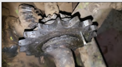
شکل ۲۵- جوش دادن چرخ زنجیر
