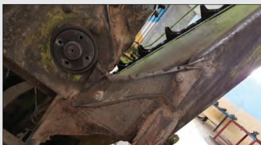
شکل ۳۲- پیچ‌های متصل به تیغه ثابت
