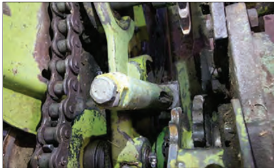
شکل ۴۳- اهرم و پیچ تنظیم تیغه ثابت
