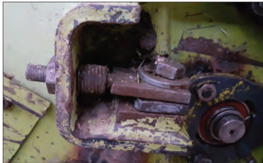
شکل ۴۲- پیچ تنظیم تیغه ثابت
