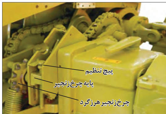
شکل ۷- زنجیر سفت کن با چرخ زنجیر واسطه
