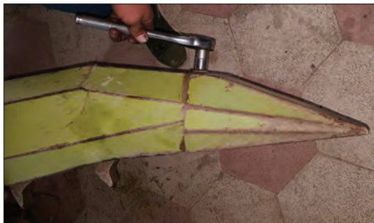
شکل ۲۲- تعویض کلگی دماغه
