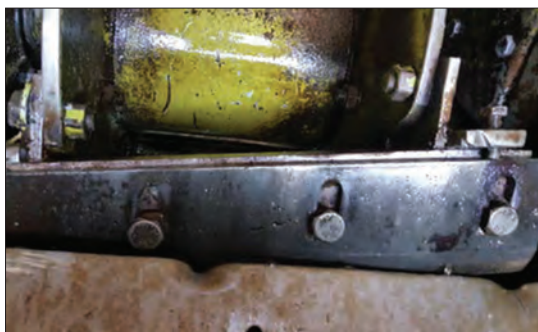
شکل ۴۴- پیچ و شیارهای رگلاژ تیغه متحرک
