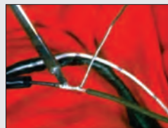
ج) تاباندن سیم‌ها و لحیم‌کاری آنها
