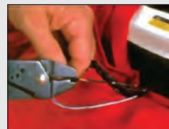
الف) لخت کردن سیم در محل قطعی
