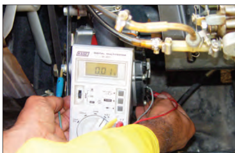
شکل ۳۰- آزمایش اجزای داخلی آلترناتور
