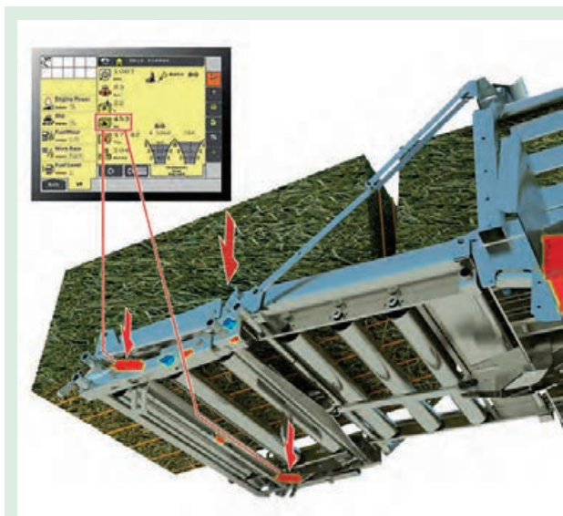
شکل ۴۹- کاربرد لودسل در بسته‌بند مکعبی
