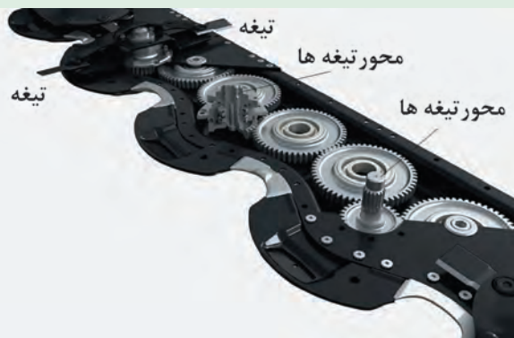
شکل ۵۱ - چرخ دنده‌های محرک تیغه‌ها در دروگر بشقابی
