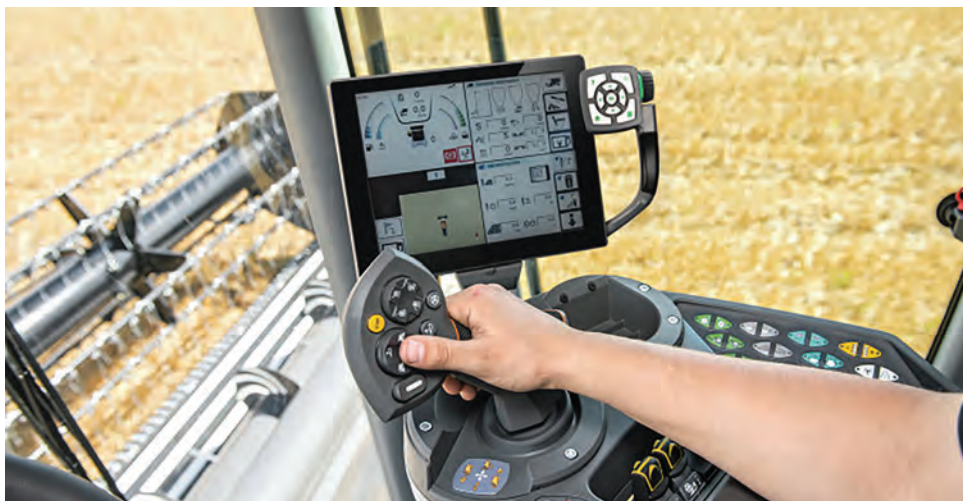
شکل ۱۵- نمونه‌ای از سامانه نظارت بر عملکرد کمباین
