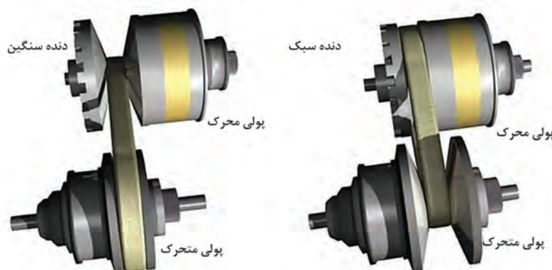
شکل ۶۲- نحوه عملکرد پولی‌های با قطر متغیر
