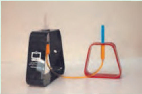
شکل ۱۰- آزمایش اصل تشدید نیرو
