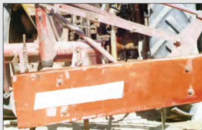
شکل ۷- باز کردن حفاظ تسمه‌ها
