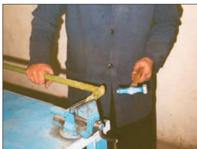
شکل ۱۵- صاف کردن پایه بلبرینگ
