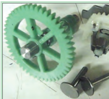
۱۲- میل بادامک را به بیرون هل داده و بالابرها سوپاپ‌ها را بردارید.
