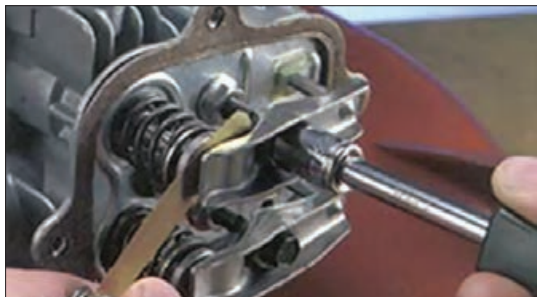
شکل ۳۵- فیلر کردن سوپاپ
