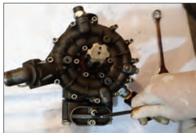
شکل ۴۸ - باز کردن درپوش سوپاپ‌ها
