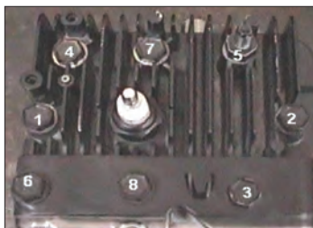
شکل ۳۴- ترتیب بستن پیچ‌های سرسیلندر
