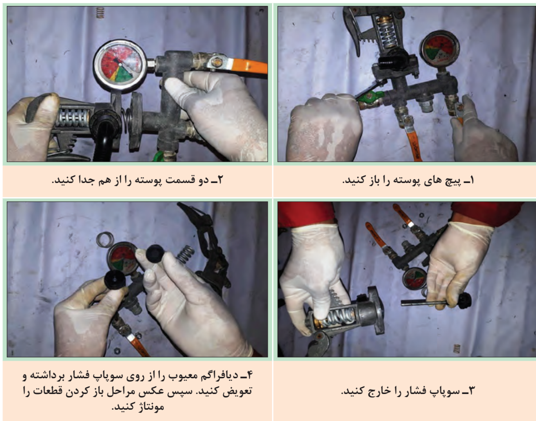
شکل ۵۲- تعویض دیافراگم رگولاتور مدل کمت
