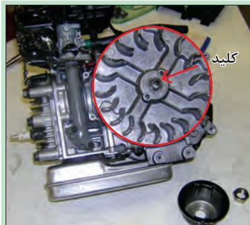
۳- فلایویل را بعد از باز کردن مهره آن به وسیله ضربات چکش لاستیکی یا پولی کش جدا کنید.
