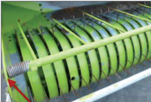
شکل ۳۴- خار میله راهنما (میله فشاردهنده)
