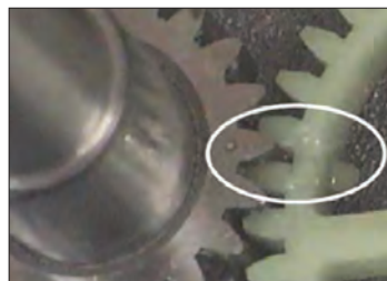
شکل ۳۳- علامت تایم کردن میل بادامک
