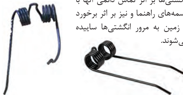
شکل ۴- تفاوت انگشتی سالم و انگشتی معیوب
