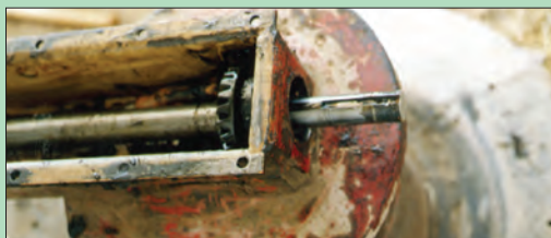
شکل ۲۸- خارج کردن محور افقی از محل درپوش
