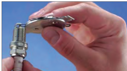
شکل ۲۱- کنترل فاصله الکترودهای شمع با فیلر مخصوص شمع
