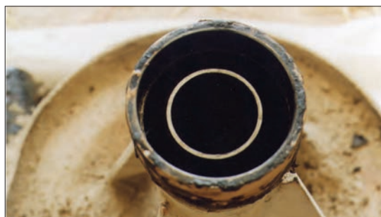
شکل ۴۳- ساییدگی جای بلبرینگ
