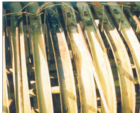
شکل ۶- ساییده شدن انگشتی‌ها به تسمه‌های راهنما
