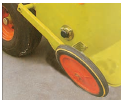
شکل ۲۸- چرخ تنظیم کج شده
