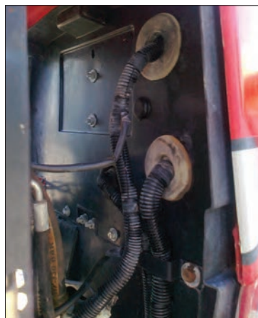
شکل ۳- ثابت کردن کلاف روی بدنه تراکتور
