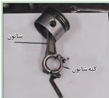
۱۳- پیچ‌های کپه یاتاقان را باز کرده و آن را بردارید. به جهت شاتون و کپه دقت کنید.
