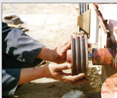
شکل ۱۱- برداشتن چرخ تسمه
