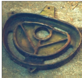
شکل ۱۸- صفحه بادامکی معیوب
