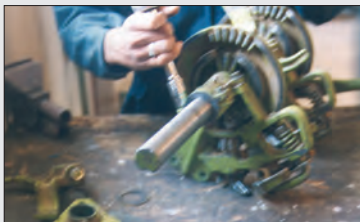
شکل ۷۶- پیاده کردن محور گره‌زن و اجزای آن
