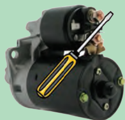
شکل ۴۳- اتصال کوتاه موتور استارت
