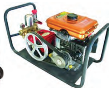
شکل ۱۹- انتقال قدرت در سم پاش های زنبه ای
