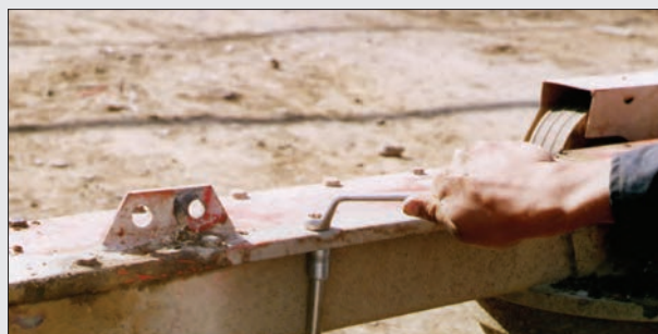
شکل ۲۰- باز کردن پیچ‌های سرپوش جعبه دنده
