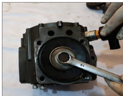
شکل ۴۶- باز کردن دیافراگم
