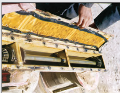
شکل ۲۱- برداشتن سرپوش جعبه دنده
