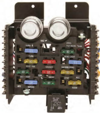
شکل ۸- جعبه فیوز یک نمونه تراکتور
