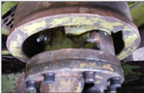
شکل ۴۸- پیچ‌های اتصال کلاچ به یوک چهارشاخه گاردان
