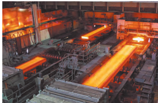
شکل ۲ ▲ نورد گرم ورق فولادی
