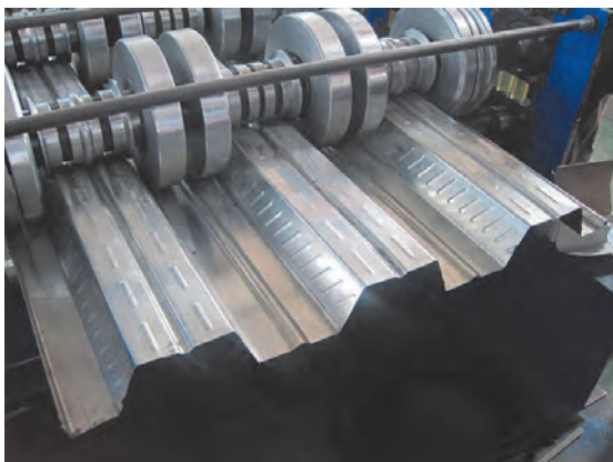
شکل ۳۵ ▲ روش تولید ورق عرشه فولادی
