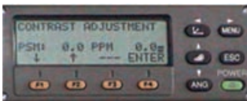
کلیدها و صفحه نمایش توتال استیشن تاپکن سری ۲۲۰-GTS
