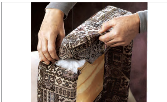
شکل ۴-۳۷- تنظیم پارچه گوشه‌ها
