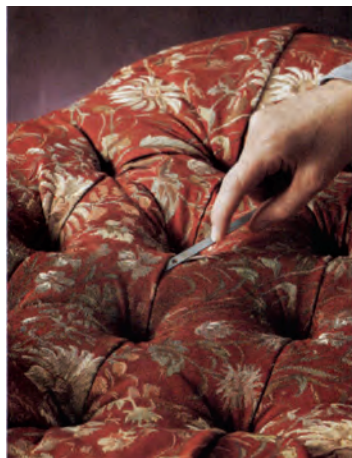
شکل ۴-۶۳- تنظیم لمسه با انتهای سوزن
