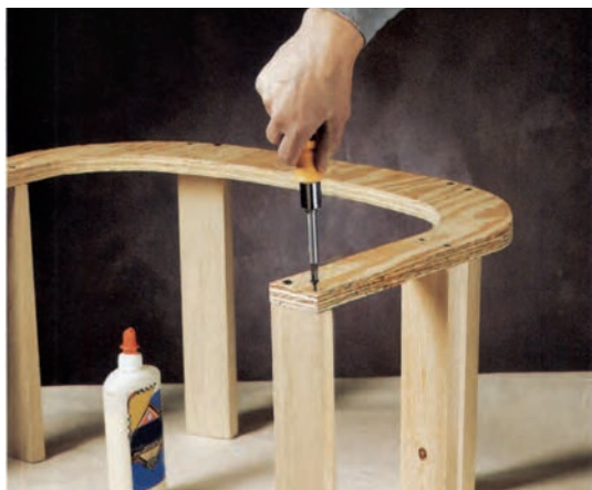
شکل ۴-۲۱- پیچ کردن قیدها به پایه
