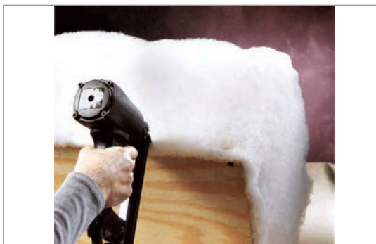
شکل ۴-۳۹- نصب اسفنج به بدنه صندوقچه
