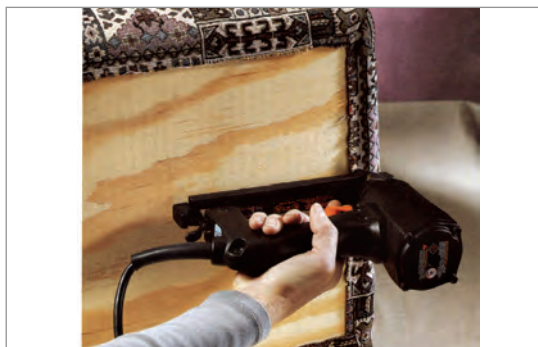
شکل ۴-۴۰- نصب پارچه در زیر صندوقچه
