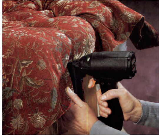
شکل ۴-۶۴- منگنه زدن لبه پایین
