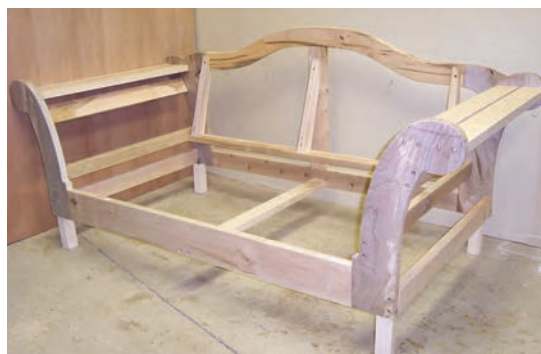
شکل ۴-۴ - تصویری از یک کلاف چوبی مبل پارچه‌ای
