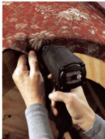
شکل ۴-۶۷- کشیدن و کوبیدن پارچه و کوبیدن پایه زیر کف شکل ۴-۶۸- نصب پایه زیر کف
