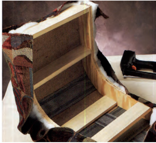
شکل ۴-۲۶- نصب قسمت‌های صاف
