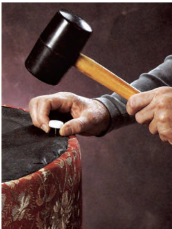
شکل ۴-۶۷- کشیدن و کوبیدن پارچه و کوبیدن پایه زیر کف شکل ۴-۶۸- نصب پایه زیر کف
