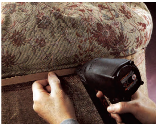
شکل ۴-۷۰- کوبیدن زهوار زیر سرمه با منگنه
