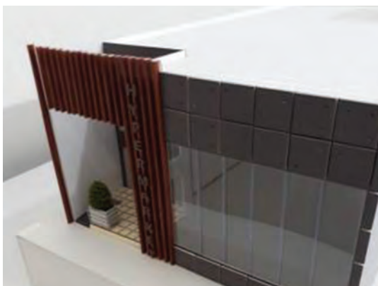
شکل ۵-۸۷- ساخت نمای چوبی: چسباندن برجسب‌های طرح چوب دور چوب بالسا شکل ۵-۸۸- ساخت نمای شیشه‌ای با استفاده از طلق شفاف و ایجاد شیار بر روی آن
