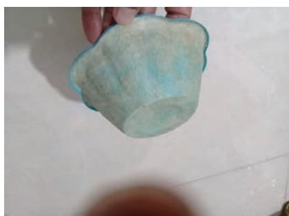
شکل ۴۶-۵ جداسازی پوشش از قالب اصلی
