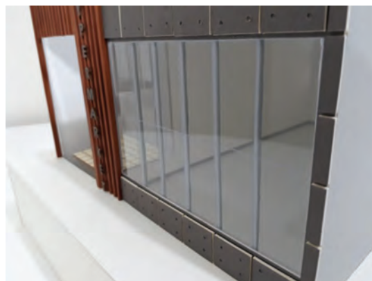
شکل ۵-۸۹- نصب شیشه‌های ساخته شده بر روی نما
