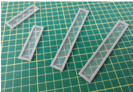
شکل ۵-۵۸- برش قطعات دیواره‌های یخچال
