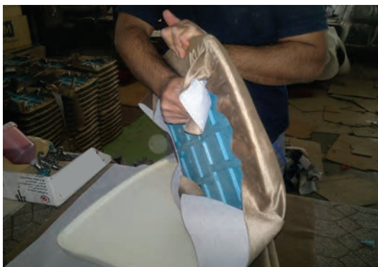
شکل ۵-۵۱ کشیدن و تنظیم پارچه
