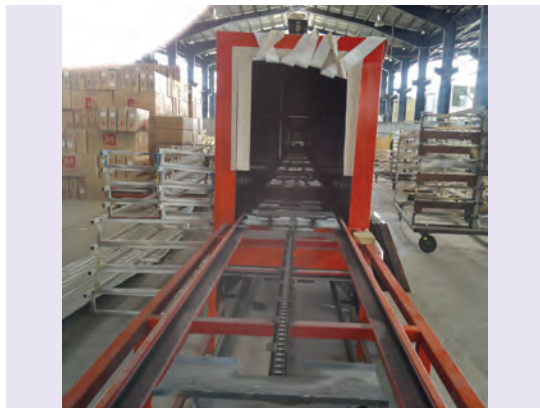
شکل ۳۹-۵- تونل خشک کن رنگ
