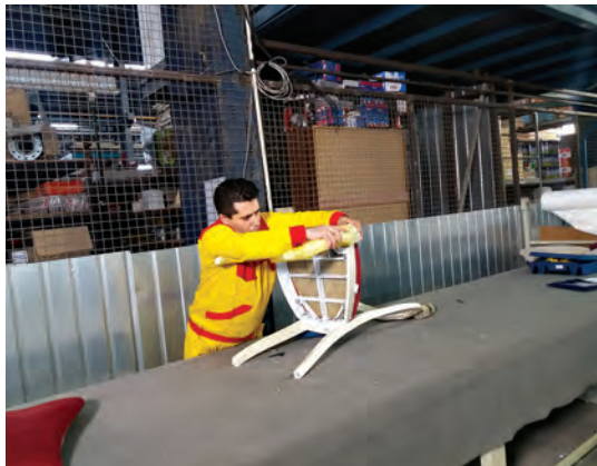
شکل ۷۷-۵- جا زدن و تنظیم پایه جلو
