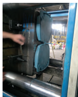
شکل ۲۶-۵- جدا کردن قالب
