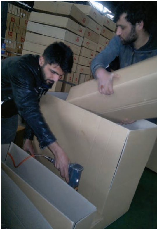
شکل ۶۷-۵- بستن کارتن با زدن منگنه
