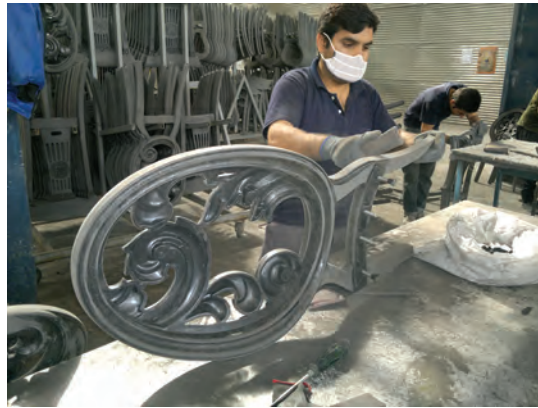
شکل ۲۹-۵- پرداخت با دست
