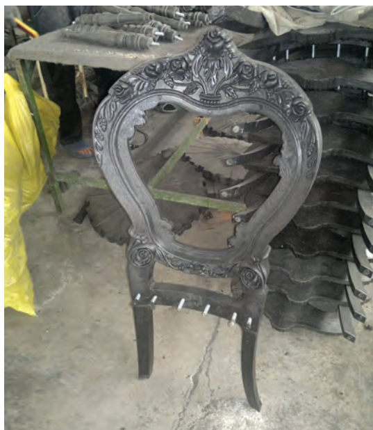
شکل ۵-۶۴- پیچ‌های اتصال قطعات
