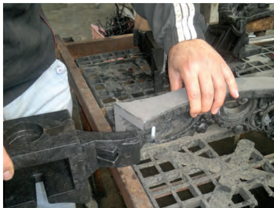
شکل ۲۴-۵- قرار دادن پیچ و مهره
