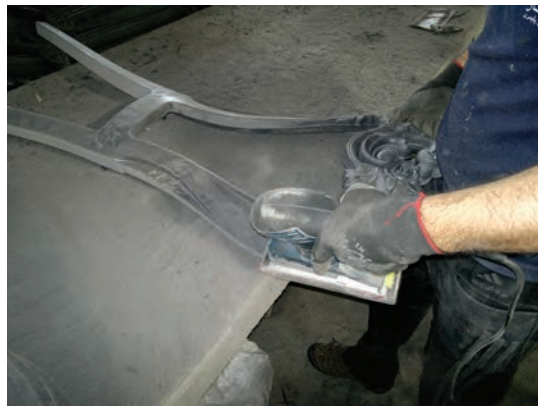
شکل ۳۱-۵- پرداخت پشت صندلی با سنباده لرزان
