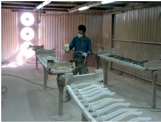
شکل ۳۶-۵- پاشیدن بتونه یا رنگ با پیستوله
