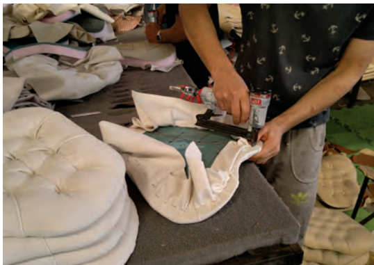
شکل ۵-۵۴ - منگنه زنی لبه‌های قطعه لمسه کاری شده
