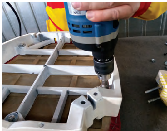
شکل ۵-۷۳- بستن شبکه زیر صندلی به کف
