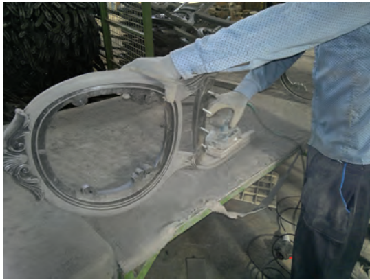
شکل ۳۰-۵- پرداخت با سنباده لرزان
