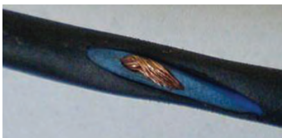
شکل ۳-۱۸- پوسیدگی و زخمی شدن سیم‌ها و کابل‌ها
