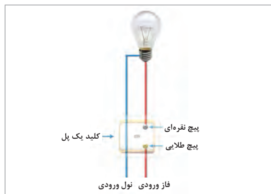
شکل ۳-۳۵- مدار الکتریکی کلید یک پل
