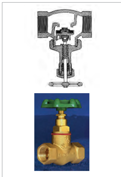
شکل ۴-۱۶ ب - شیر فلکه کف فلزی
