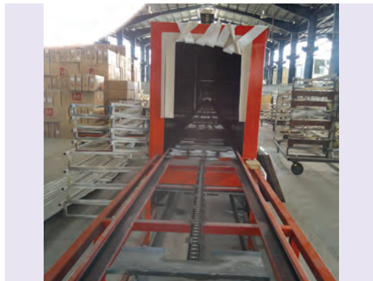
شکل ۳۹-۵- تونل خشک کن رنگ
