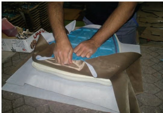
شکل ۵-۵۰ ثابت کردن پارچه از یک طرف
