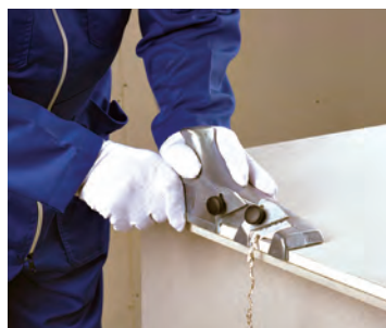
شکل ۱-۱۹۱- پخ زدن لبه‌ها
