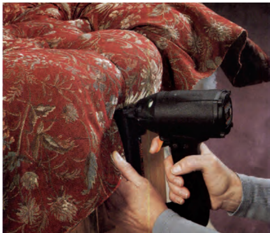
شکل ۴-۶۴- منگنه زدن لبه پایین
