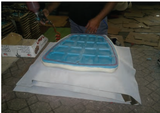
شکل ۵-۴۹ کشیدن پارچه روی کف صندلی
