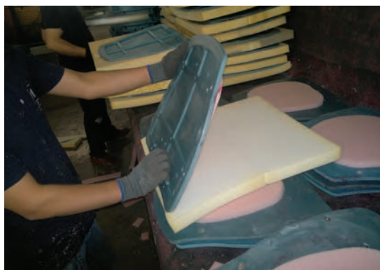
شکل ۵-۴۷- قراردادن کفی روی اسفنج بزرگ‌تر
