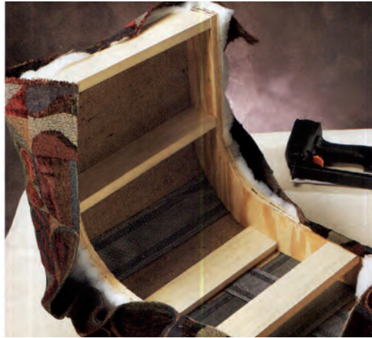
شکل ۴-۲۶- نصب قسمت‌های صاف
