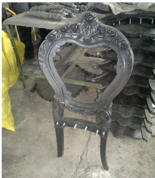
شکل ۵-۶۴- پیچ‌های اتصال قطعات
