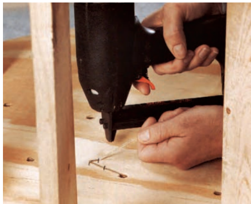
شکل ۴-۶۰- ثابت کردن نخ لمسه از پشت تخته
