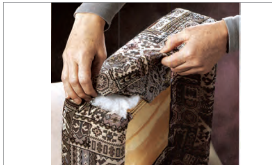
شکل ۴-۳۷- تنظیم پارچه گوشه‌ها
