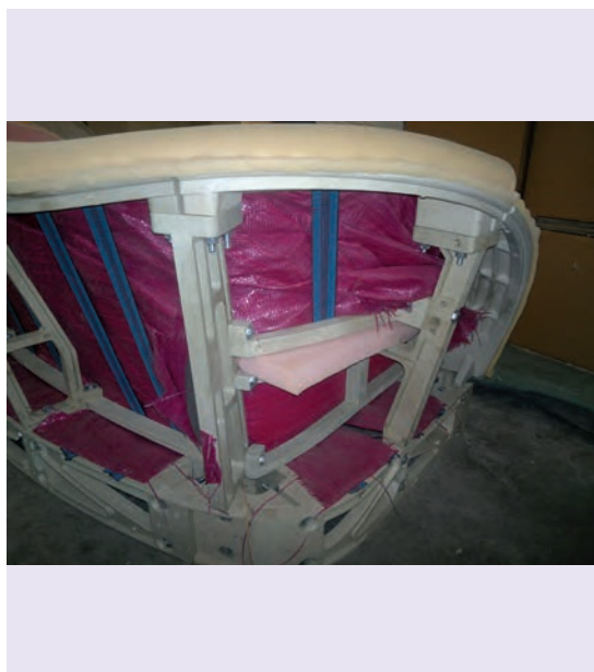
شکل ۵-۶۵- کلاف مبلمان مونتاژ شده با پیچ و مهره
