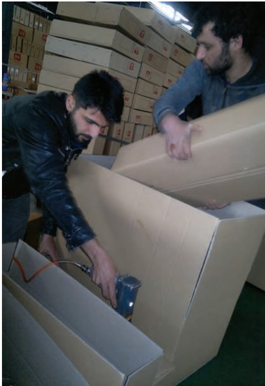
شکل ۶۷-۵- بستن کارتن با زدن منگنه
