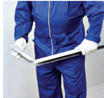
شکل ۱۲۸-۱- خم کردن انتهای رانر نعل درگاه
