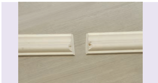
شکل ۲۲۸-۱- برش فارسی بر قطعات کنج
