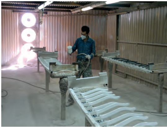
شکل ۳۶-۵- پاشیدن بتونه یا رنگ با پیستوله
