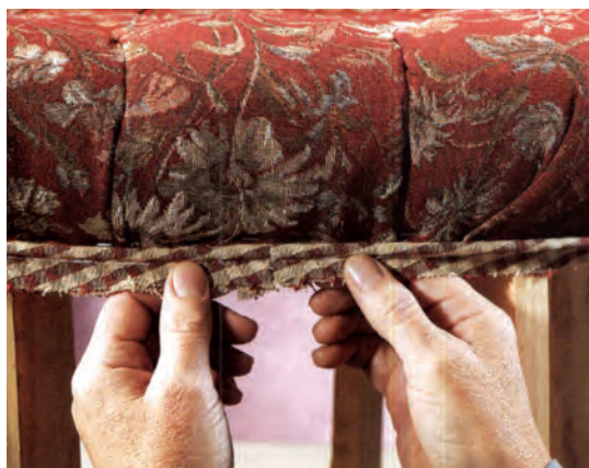
شکل ۴-۶۹- اندازه گیری و نصب سرمه
