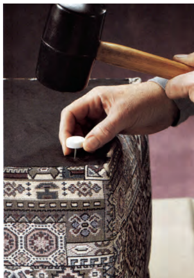
شکل ۴۳-۴- کوبیدن پایهٔ زیر کف
