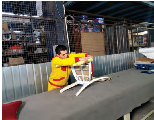
شکل ۷۷-۵- جا زدن و تنظیم پایه جلو
