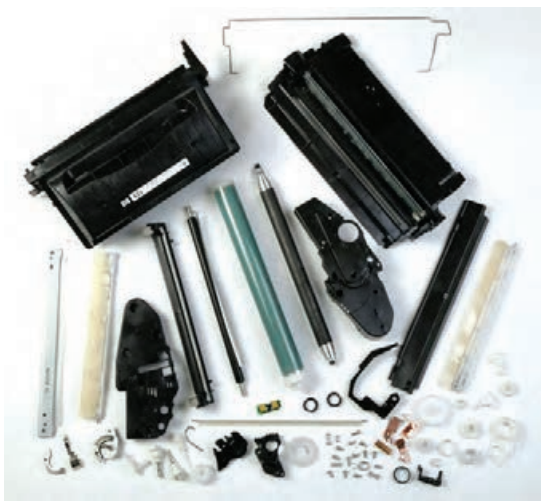
شکل ۲۸-۲ - قطعات تشکیل‌دهنده کارتریج All In
