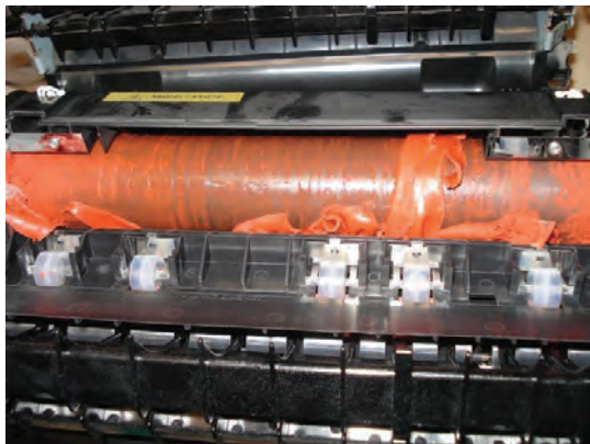
شکل ۳-۳۶- غلتک پرس معیوب
