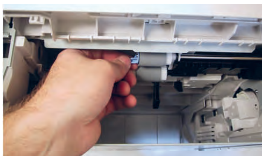
شکل ۲۲-۳ تعویض Separation Roller
