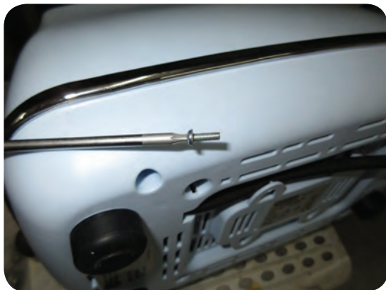
شکل ۶-۴۳ استفاده از ابزار خاص برای پیچ‌های ویژه
