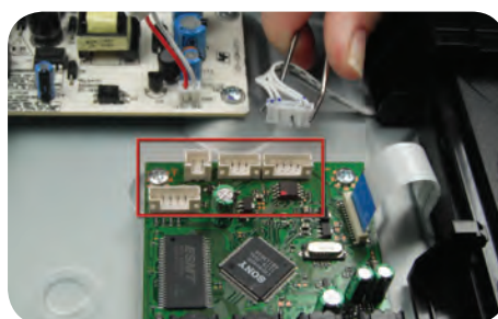
شکل ۱۹-۶ جدا کردن سوکت‌ها از برد پردازشگر
