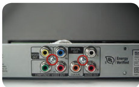
شکل ۲۲-۶ باز کردن پیچ‌نهایی برد پردازشگر
