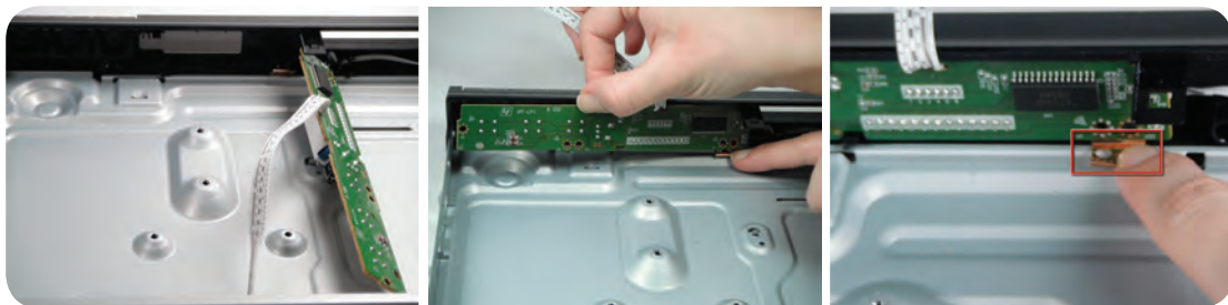
شکل ۶-۳۰ زائده سمت راست شکل ۶-۳۱ فشار دادن زائده و خارج کردن برد شکل ۶-۳۲ پنل دمونتاژ شده
