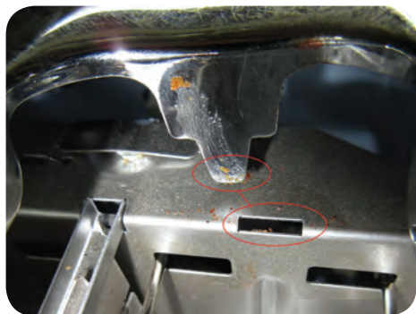
شکل ۶-۵۸ خار نر و ماده جهت اتصال
