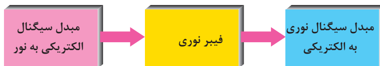
شکل ۱۰- اساس یک سیستم فیبر نوری
