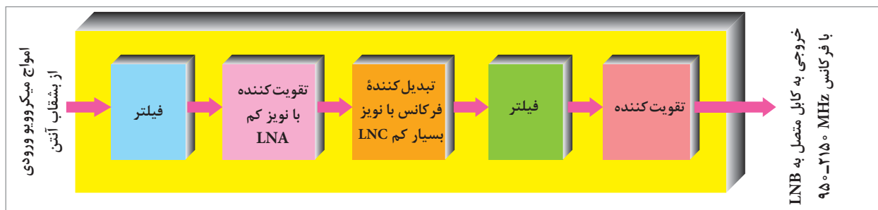
شکل ۲۱- بلوک دیاگرام ساده LNB
