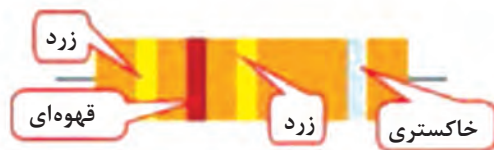
شکل ۳- دیود با نوارهای رنگی
