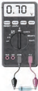
شکل ۶- تعیین پایه ها و جنس دیود با استفاده از مولتی متر دیجیتالی
