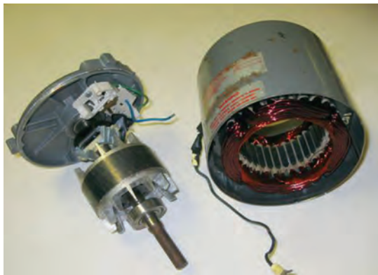
شکل ۲۰- موتور القایی تک فاز، فاز شکسته
