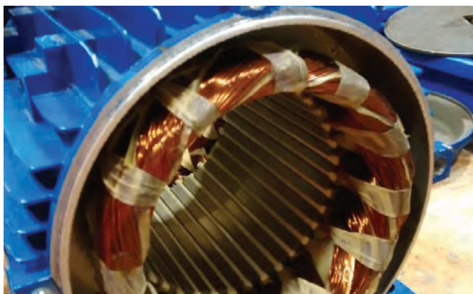
شکل ۳- استاتور موتورهای سه فاز
