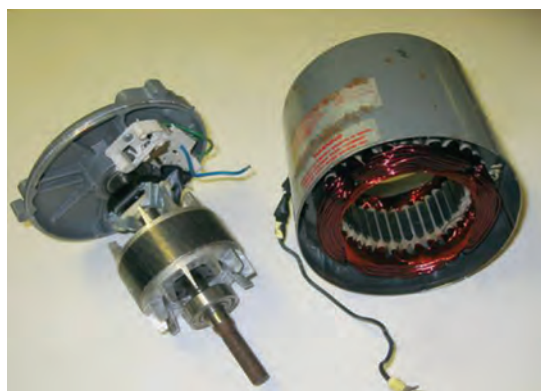
شکل ۱۸- رتور و استاتور موتور تک فاز
