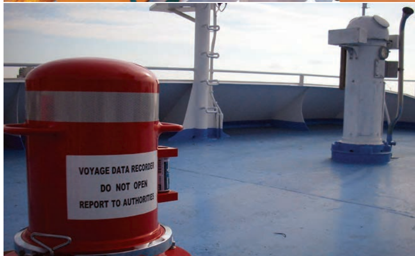
شکل ۱۸- کپسول‌های حاوی DRU نصب شده در عرشه آزاد
