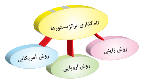
شکل ۲۰- روش‌های نام‌گذاری ترانزیستورها
