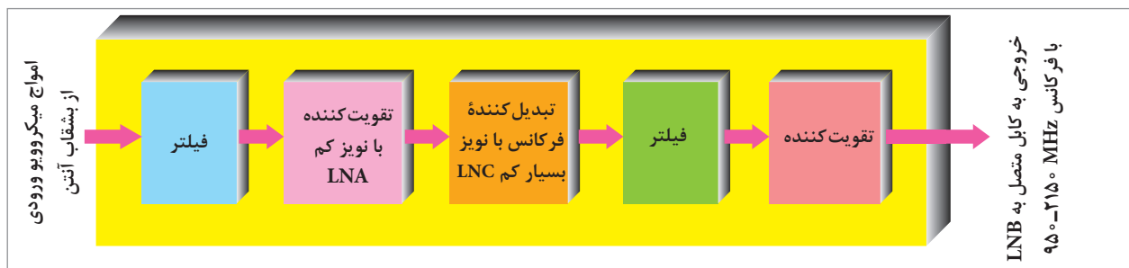
شکل ۲۱- بلوک دیاگرام ساده LNB
