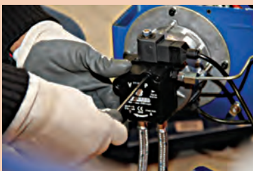
هواگیری پمپ
