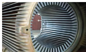
شکل ۱۰- ساختار استاتور
