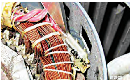
شکل ۳۶- محافظ حرارتی سیم پیچ موتور
