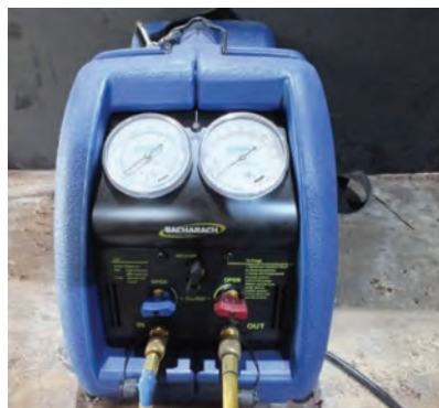
شکل ۱۵- دستگاه بازیافت گاز
