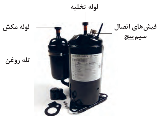
شکل ۱۶- اجزای خارجی کمپرسور
