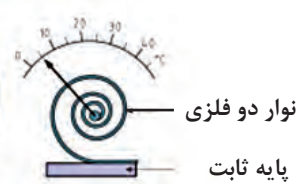
شکل ۱۰- دماسنج دوفلزی حلزونی شکل
