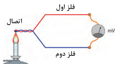
شکل ۵- نحوه اندازه گیری دما با ترموکوپل
