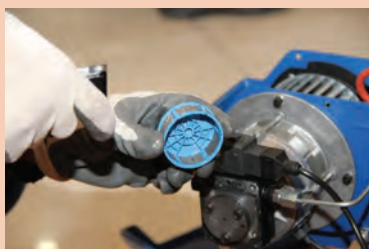
بازکردن درپوش پمپ و تمیز کردن فیلتر
