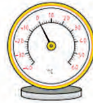
شکل ۱۰- دماسنج دوفلزی حلزونی شکل
