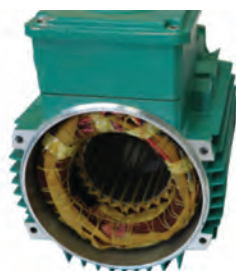
شکل ۱۰- ساختار استاتور
