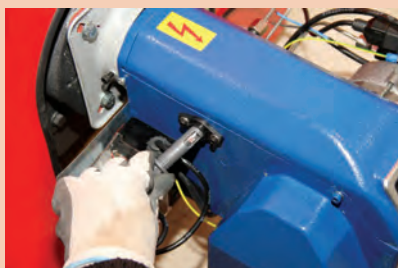
خارج کردن چشم الکتریکی
