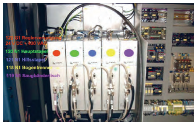
شکل ۴۲- پنج عدد درایور برای کنترل کله‌گی آپارات
