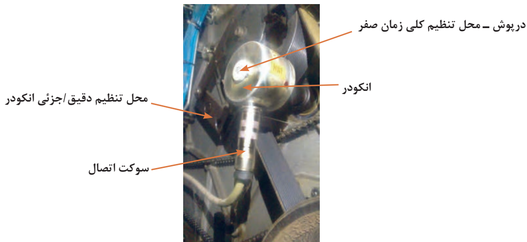
شکل ۲۵- ساختمان یک انکودر در ماشین چاپ
