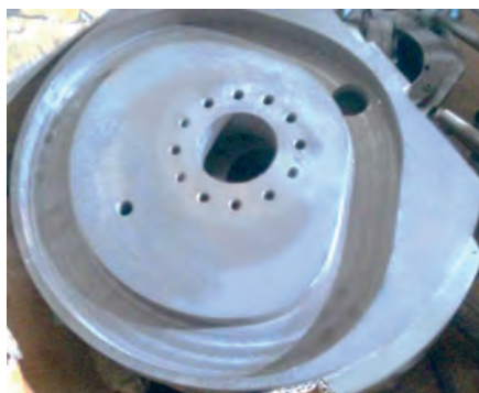
شکل ۱۴-پ) یک لنگ شیاردار در ماشین دایکات
