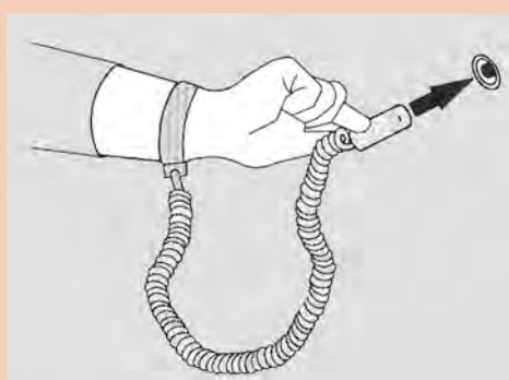
شکل ۲۷- الف) مچ بند مجهز به سیستم ارت
