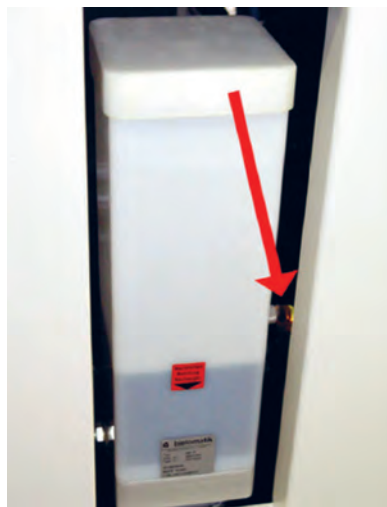
شکل ۱۲- حسگر تشخیص سطح روغن
